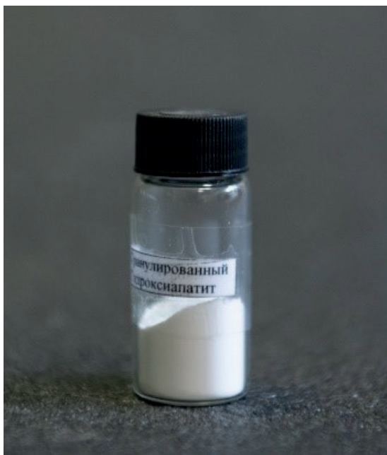
Рис. Сферический гидроксилапатит с регулируемым гранулометрическим составом
