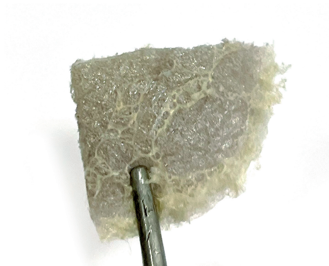
Рис. Суперабсорбирующая мембрана на основе антибактериальных полимеров курдлан/хитозан с включенными наночастицами серебра
