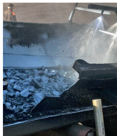
Рис. Общий вид обработки угля раствором на конвейере.
