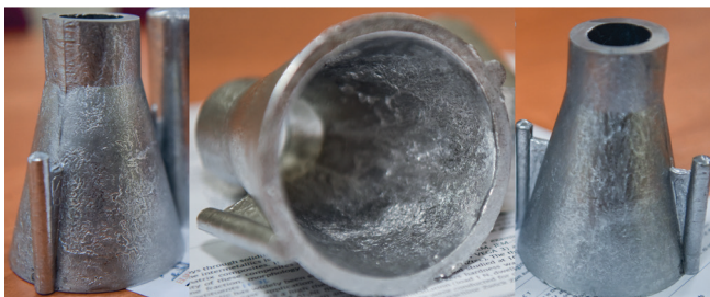
Рис. Отлитые образцы, полученные в виде фасонных разнотолщинных отливок.
