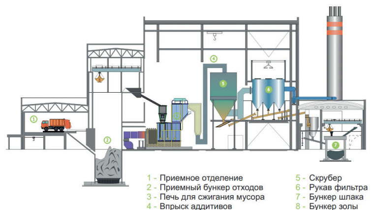
Рис. Технологическая схема утилизации твердых коммунальных отходов (ТКО) с использованием печей с барботажным слоем.
