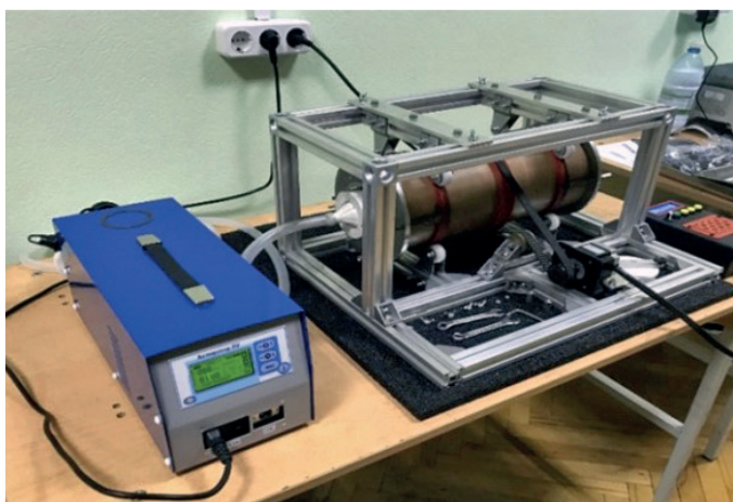
Рис. Лабораторная установка для определения содержания пыли в углях.
