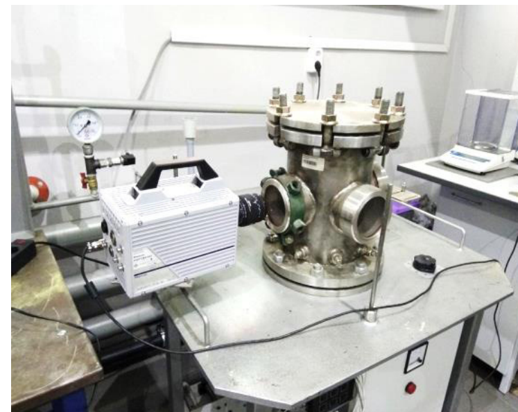
Рис. Экспериментальная установка для сжигания твердого топлива
