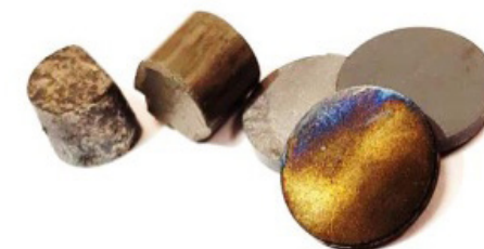
Рис. Капсулирование TiFe в защитный водородопроницаемый полимер
