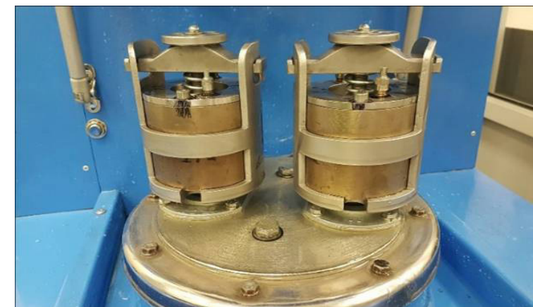
Рис. Конструкция шаровой планетарной мельницы, позволяющей с большой точностью выдерживать соотношение скоростей, т.е. режим движения шаров. При помоле одних и тех же порошков в различных режимах, можно получить существенно различающиеся результаты
