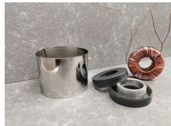
Рис. Магнитомягкий материал на основе железа, содержащий бор, фосфор, кремний, молибден и медь
