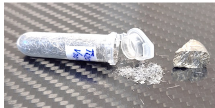
Рис. Частицы порошка сплава-накопителя водорода, покрытые пленкой барьерного полимера
