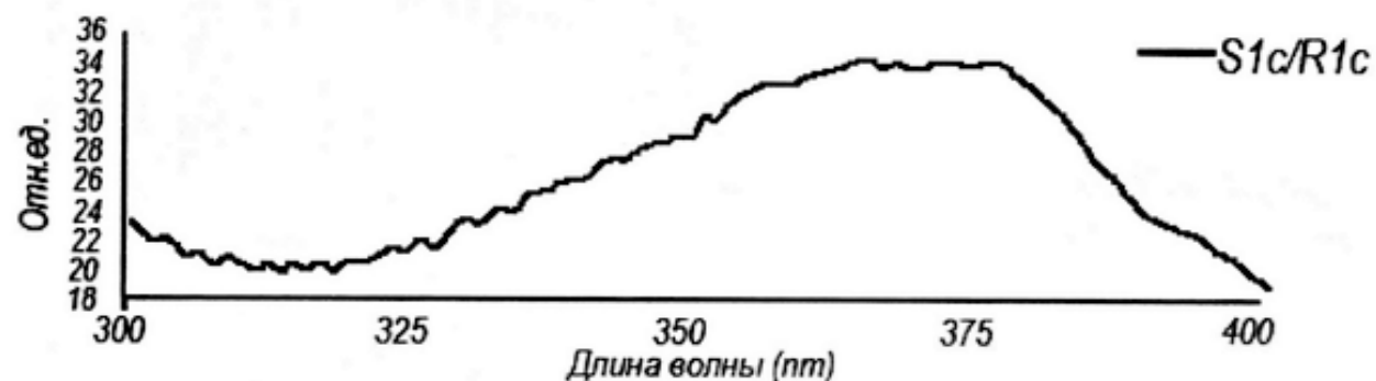
Рис. Спектр поглощения света наночастицами оксида кремния, нанесенных на стекло
