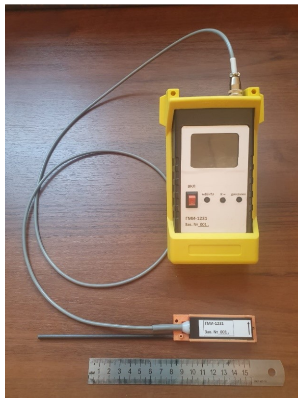
Рис. Общий вид однокомпонентного цифрового ГМИ-магнитометра
