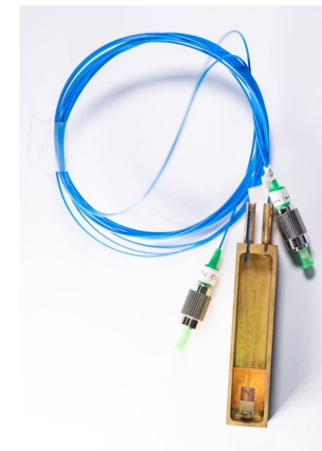
Рис.2 Водородный интегрально-оптический сенсор
