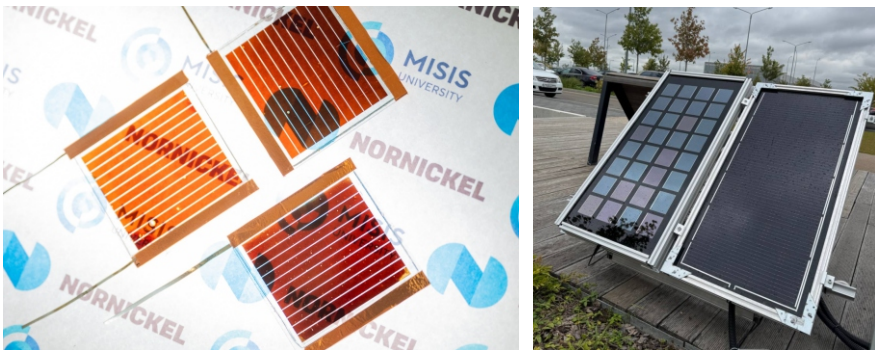
Рис. Масштабируемые полупрозрачные солнечные модули из перовскитов
