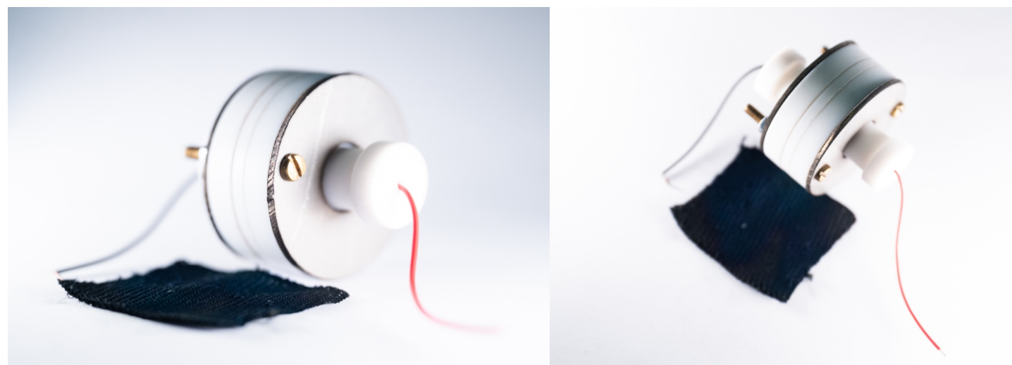
Рис. Суперконденсаторы с электродным материалом на основе композита углеродная ткань-полианилин
