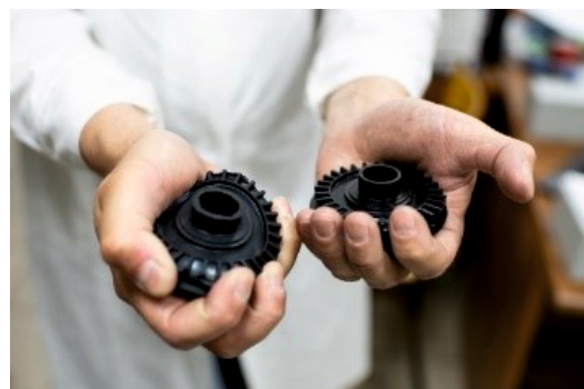
Рис. Новый композитный материал на основе шунгита и углеродных волокон в графитовой матрице
