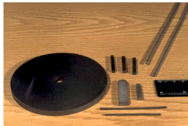
Рис. Электродные материалы для технологии ЭИЛ: дисковые; стержневые
