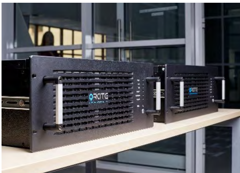
Рис. Устройство квантового распределения ключа с частотой повторения приготовления состояний до 1 ГГц и скоростью генерации квантового ключа более 100 Кбит/с
