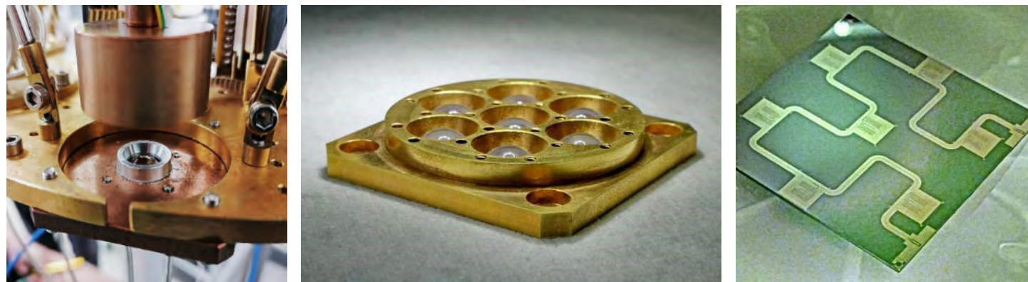
Рис. Фотографии экспериментальных образцов: (1) одиночный детектор в сверхнизкотемпературном криостате с тестовым планковым излучателем; (2) фотография чипа интегральной микросхемы с семью детекторами в гексагональной конфигурации; (3) детекторный блок с семью сапфировыми линзами, в который смонтирована микросхема (2)
