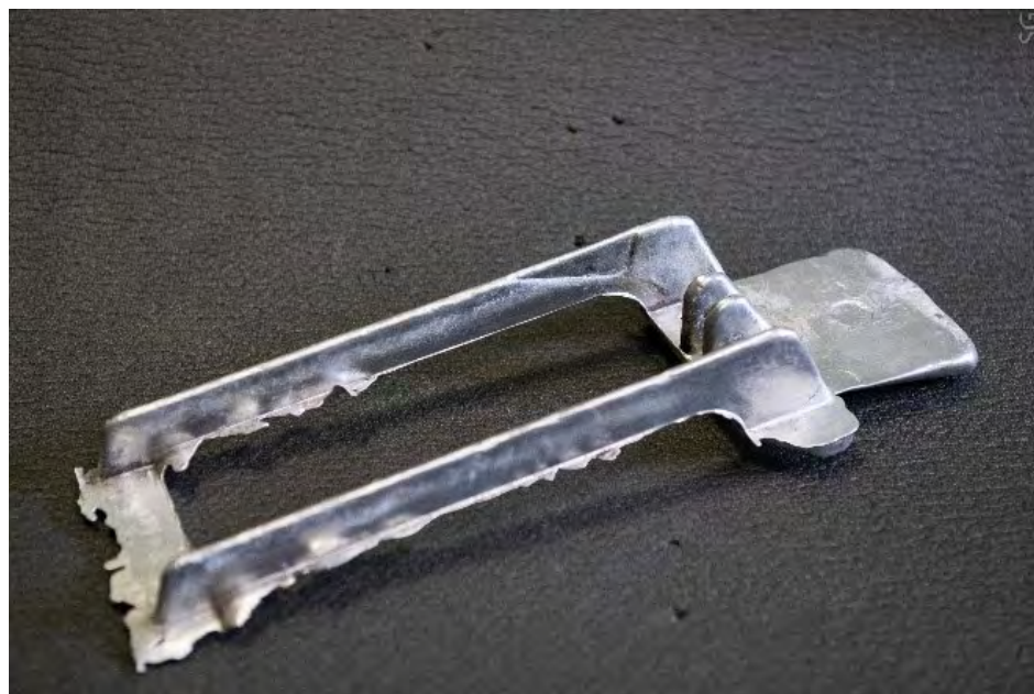
Рис. Коррозионностойкие алюминий-кальциевые сплавы. Деталь педаль.
