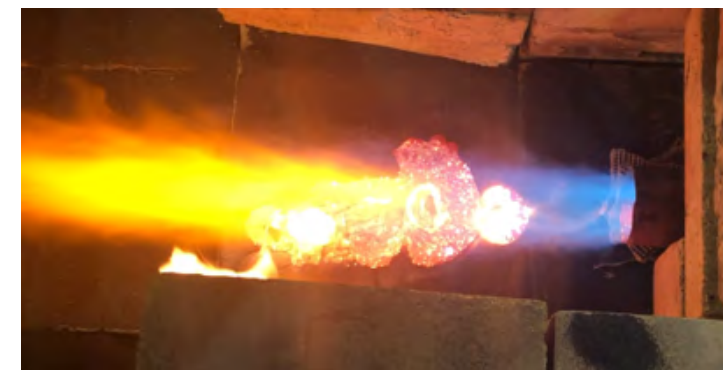
Рис. Испытания отливок МЛ10 на возгорание в пламени горелки, имитирующем открытый пожар на летательном аппарате, при 60 °С и 120 °С
