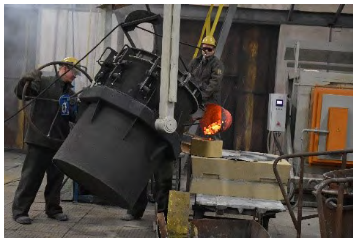
Рис. Заливка литейной формы и полученные отливки Корпус и крышка промежуточной опоры из сплава МЛ19
