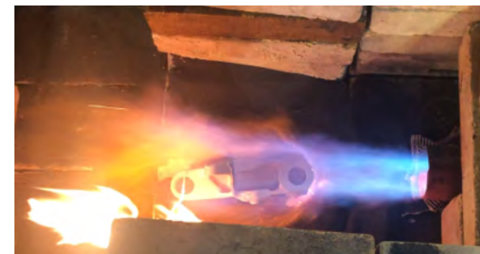
Рис. Испытания отливок МЛ10 на возгорание в пламени горелки, имитирующем открытый пожар на летательном аппарате, при 60 °С и 120 °С
