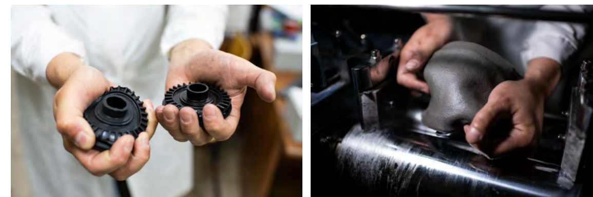
Рис. Новый композиционный материал на основе шунгита и углеродных волокон в графитовой матрице
