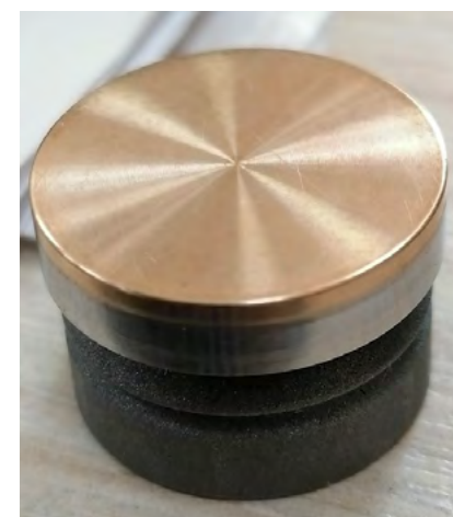
Рис. Пример биметаллических авиационных деталей, сделанных с применением литых заготовок из бронзы путем их диффузионной сварки со сталью, полученных по предлагаемой технологии
