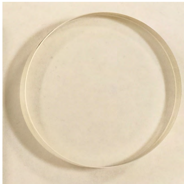
Рис. Элемент конструктивной оптики с нанесённым односторонним покрытием Zr-Si-B-N
