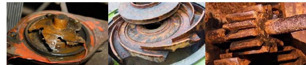
Рис. 1 Изображения деталей морской инфраструктуры после эксплуатации в коррозионной среде.
