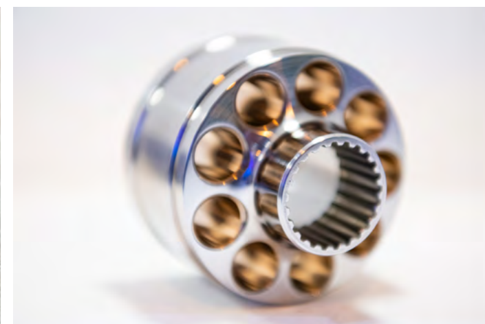
Рис. Пример биметаллических авиационных деталей, сделанных с применением литых заготовок из бронзы путем их диффузионной сварки со сталью, полученных по предлагаемой технологии
