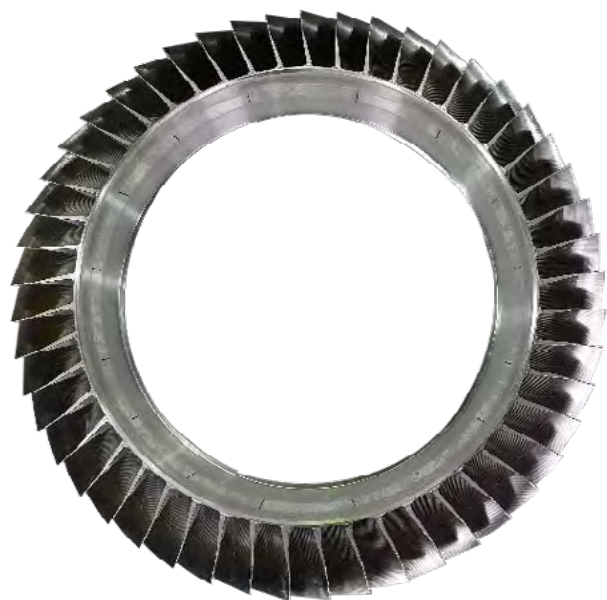
Рис. Армированная деталь из титановых сплавов для перспективных авиационных газотурбинных двигателей
