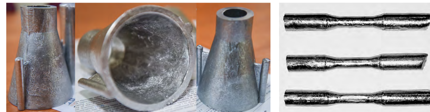
Рис. 1 Отлитые образцы, полученные в виде фасонных разнотолщинных отливок
