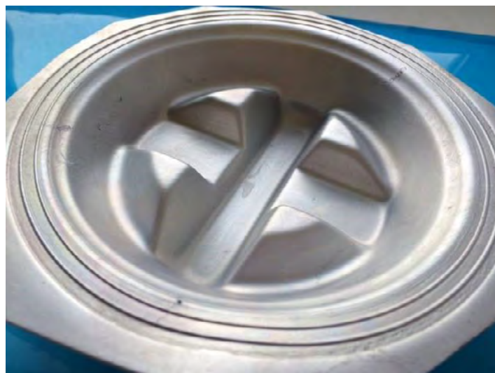
Рис. Модельные детали, полученные методом сверхпластической формовки: модель «крест» (а), модель «купол» (б)
