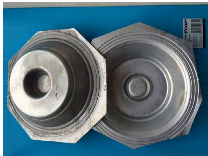
Рис. Модельные детали, полученные методом сверхпластической формовки: модель «крест» (а), модель «купол» (б)
