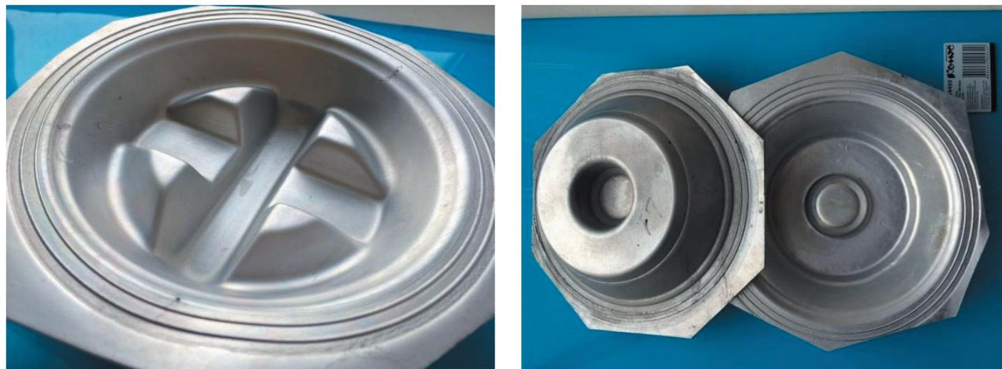
Рис. Модельные детали, полученные методом сверхпластической формовки: модель «крест» (а), модель «купол» (б)
