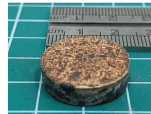
Рис.2 Образец после испытания в высокоскоростном воздушном потоке
