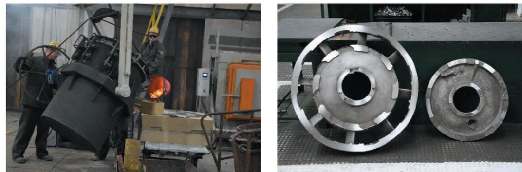
Рис. Заливка литейной формы и полученные отливки Корпус и крышка промежуточной опоры из сплава МЛ19
