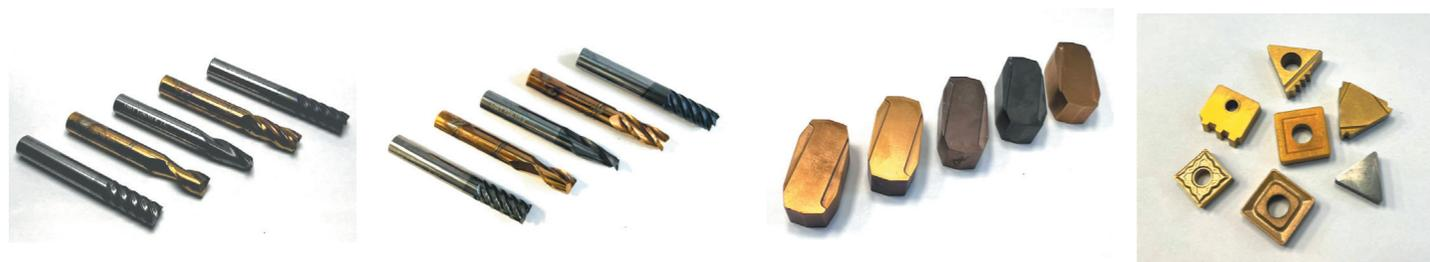
Рис. Упрочняющие arc-PVD покрытия на твёрдосплавном (ВК, ТК, ТТК) режущем инструменте
