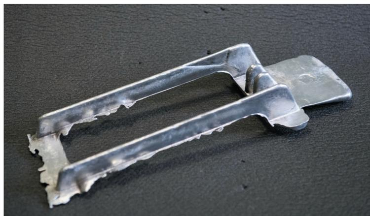
Рис. Коррозионностойкие алюминий-кальциевые сплавы. Деталь педали
