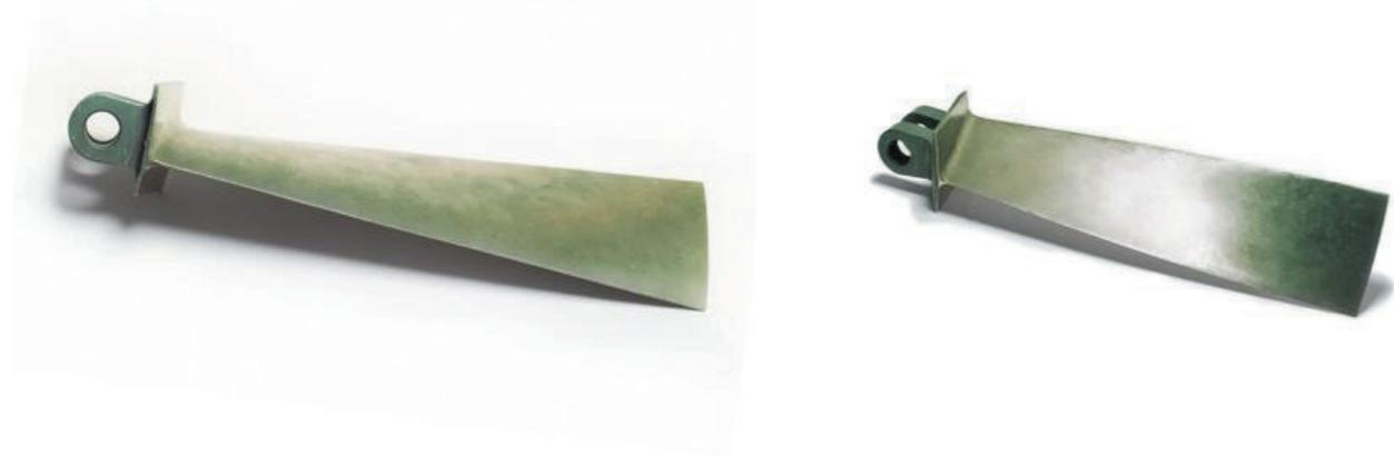
Рис. Защитные покрытия для интерметаллического сплава на основе гамма-алюминид титана
