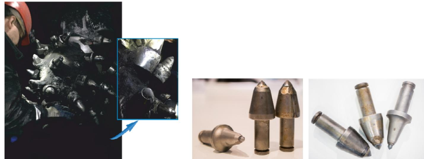
Рис. Высокоэффективное иерархические твердые сплавы с повышенной трещиностойкостью и износостойкостью
