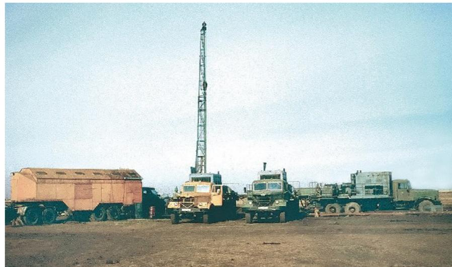
Рис. Гидродинамическая обработка угленосной толщи насосными агрегатами
