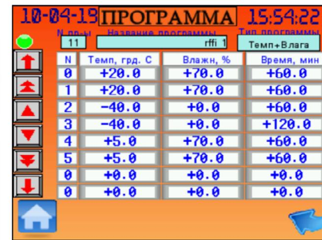
Рис. Размещение образцов углей в климатической камере и программирование режимов криогенных воздействий
