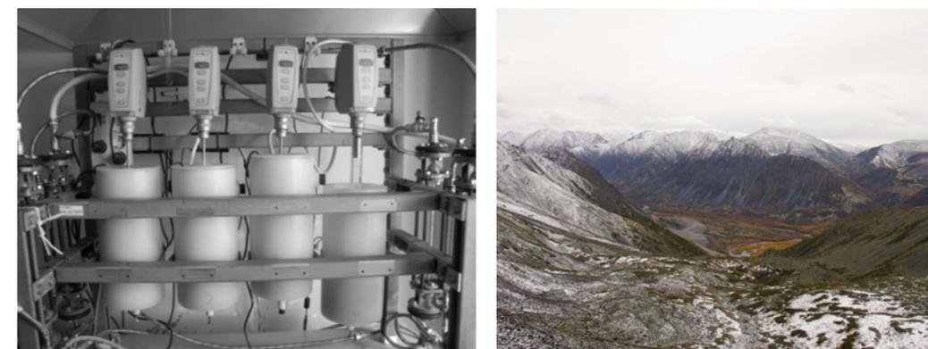
Рис. Каскад реакторов для выщелачивания с перемешиванием пероксоном
