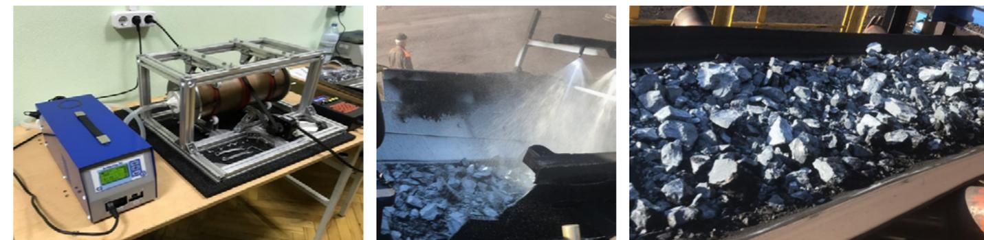
Рис. 1 Лабораторная установка для определения содержания пыли в углях
