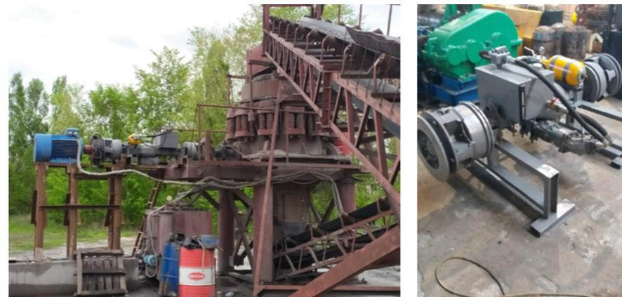
Рис. 1 Установка опытного образца в привод дробилки
