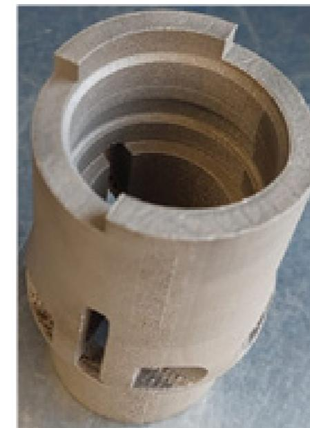
Рис. Элемент защиты ЯЭУ типа ВВЭР
