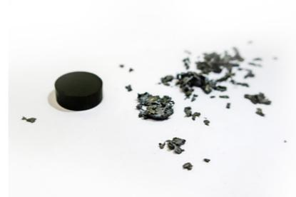
Рис. 2 Композиционный образец накопителя водорода
