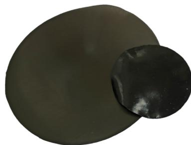
Рис. 1 Композиционные образцы мембран для очистки водорода на основе LaNi<sub>5</sub> с полиэтиленом (LaNi<sub>5</sub>/PE)
