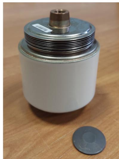
Рис. Наноконкомпозитные материалы на основе металлических псевдосплавов для контактов переключателей мощных электрических сетей
