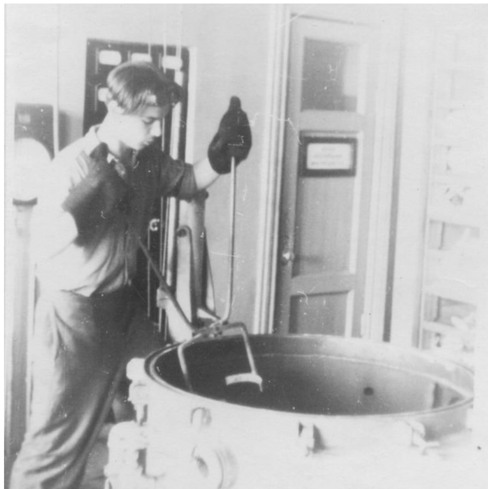
На практике на Североникеле, г. Мончегорск, запуск индукционной печи. 1949 г.
