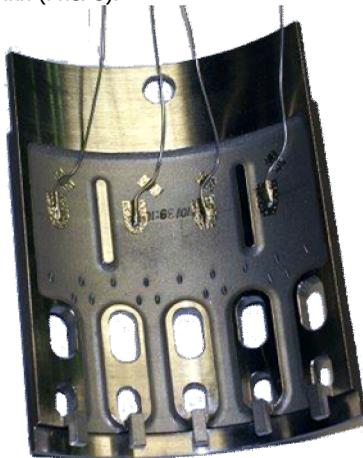
Рис. 8. Препарированный сегмент перед сборкой в отсек.
