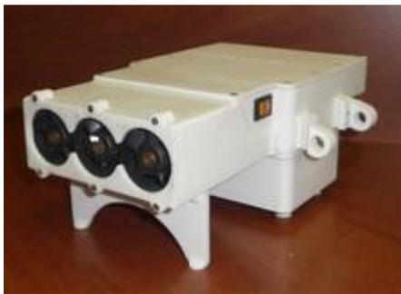
пары жидкости от межфазной границы, а полученная парогазовая смесь удаляется из устройства. Установка не требует использования сжатого газа в баллонах, при соблюдении правил эксплуатации отсутствует вероятность перекрестного загрязнения образцов.
