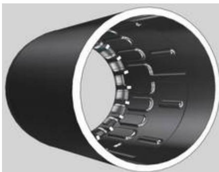
Рис.6. Доработанная CAD модель заготовки сегментов жаровой трубы.
