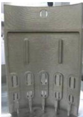
Рис. 4. Заготовка одиночного сегмента изготовленная селективным лазерным сплавлением металлопорошковой композиции CoCrMo.
