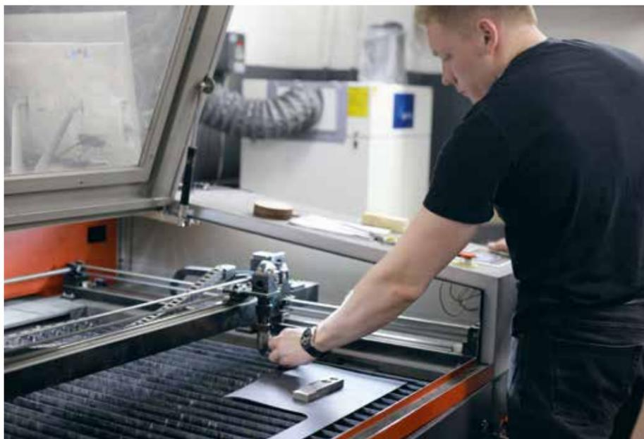
Начальник опытного производства магистр кафедры ИТО Егор Шешенин вырезает детали на лазере
