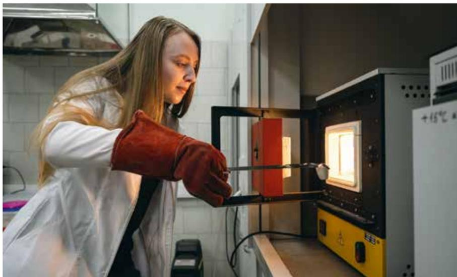
Идут лабораторные исследования: определение зольности угля в муфельной печи
