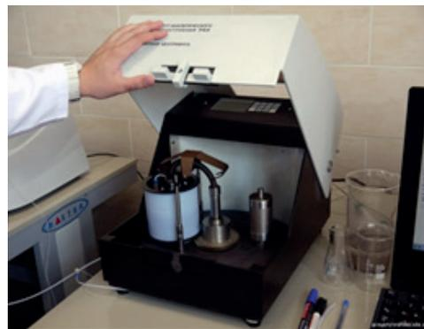
Планетарная центрифуга, оснащенная вращающейся спиральной колонкой, для разделения нано- и микро-частиц
