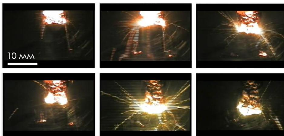
Рисунок 63 – Последовательность изображений, которые демонстрируют пульсирующий тип горения при низком давлении инертного газа ( $P = 0.1$  МПа)
