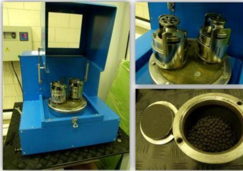
Рисунок 33 – Устройство мельницы Активатор-2S
