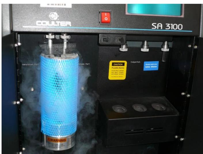
Рисунок 36 – БЭТ анализатор Coulter SA3100
