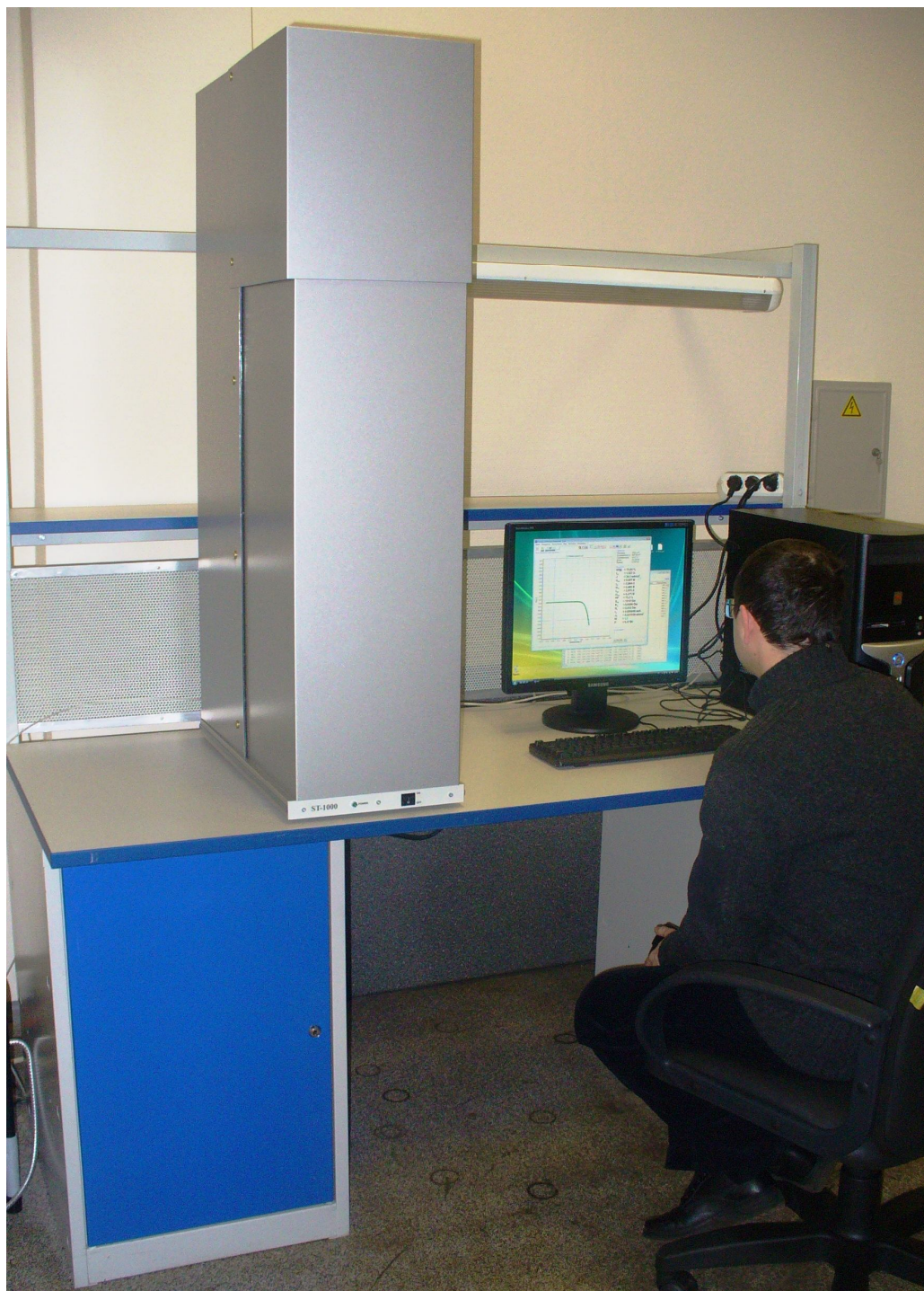
Рисунок 12 - Установка «Автоматизированное рабочее место для функционального тестирования солнечных элементов» в рабочем состоянии
