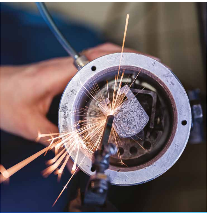
Процесс электроискрового легирования нового покрытия на основе карбида тантала
