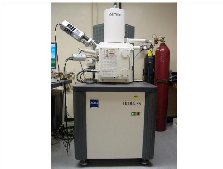
Рисунок 2.4 – Изображение сканирующего электронного микроскопа Carl Zeiss ULTRA 55, FE-SEM.
