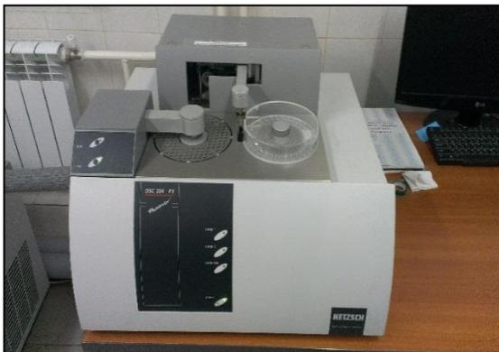
Рисунок 2.5 – DSC салориметр (DSC 204 F1 Phoenix - Netzsch Instruments)
