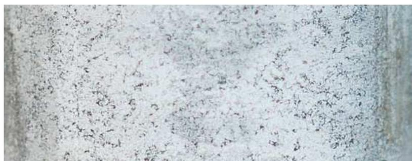
Рисунок 61 – Внешний вид образца сплава АД31 после испытаний при периодическом погружении в 3 % NaCl
