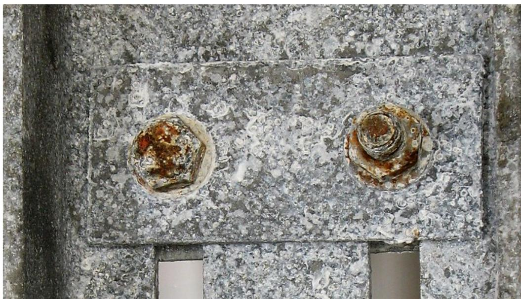
Рисунок 49 – Коррозия стальных болтов, вкрученных в оцинкованную стальную пластину, после 150 суток в камере соляного тумана
