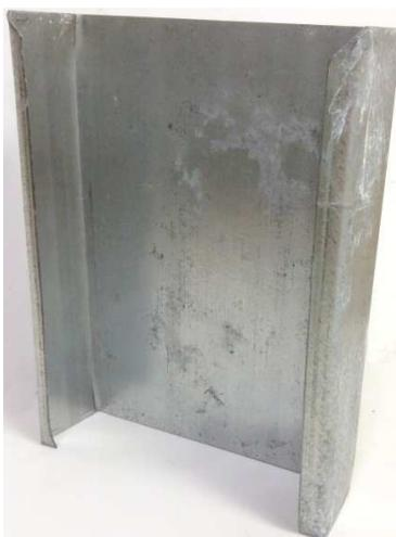
Рисунок 43 – Внешний вид поверхности, оцинкованной стали в контакте со стекляноватным утеплителем с фенолформальдегидным связующим, после выдержки в климатической камере в течение 60 суток
