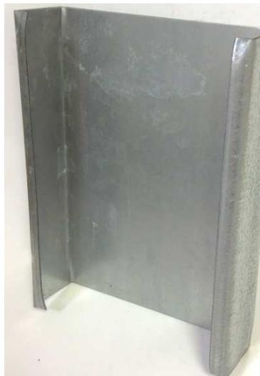
Рисунок 42 – Внешний вид поверхности образца в контакте со стекляноватным утеплителем с растительным связующим, после выдержки в климатической камере
