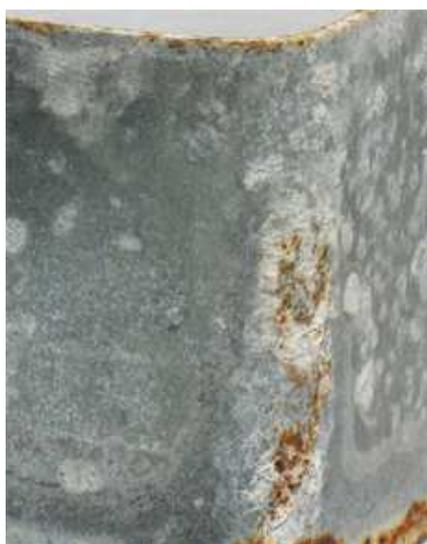
Рисунок 46 – Внешний вид оцинкованной стали при контакте с каменноватным утеплителем с фенолформальдегидным связующим после выдержки в климатической камере в течение 120 циклов
