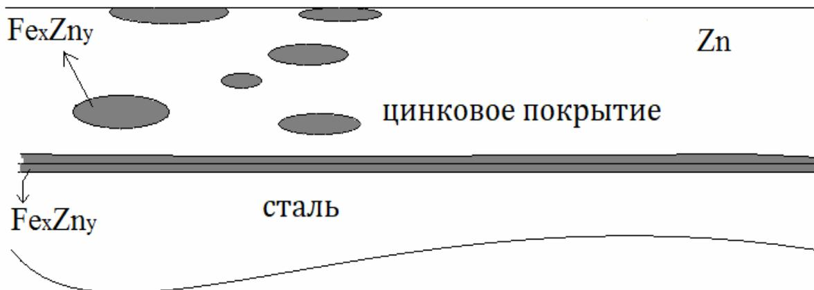
Рисунок 47 – Структура цинкового покрытия, полученного на стали методом горячего цинкования
