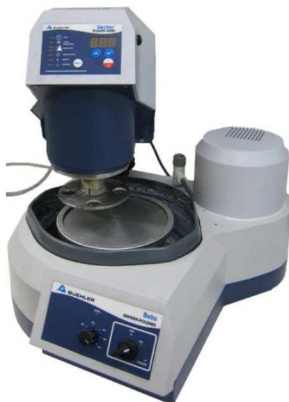
Рисунок 13 – Внешний вид шлифовально-полировального станка «Vector Phoenix Beta»
