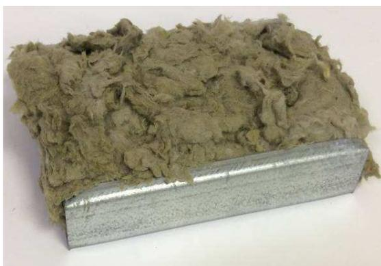
Рисунок 19 – Оцинкованная сталь с утеплителем из каменных волокон со связующим на основе фенолформальдегидной смолы
