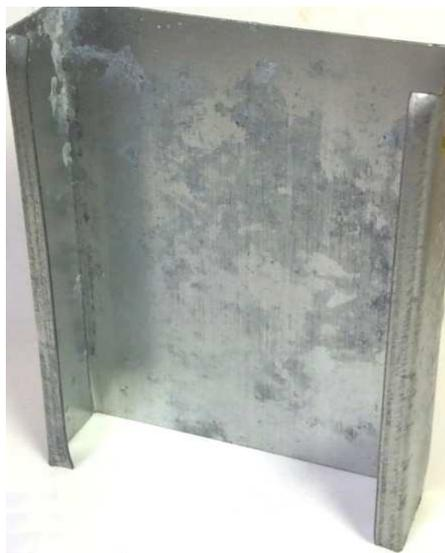
Рисунок 44 – Внешний вид поверхности оцинкованной стали при контакте с каменноватным утеплителем с фенолформальдегидным связующим, после выдержки в климатической камере в течение 60 суток
