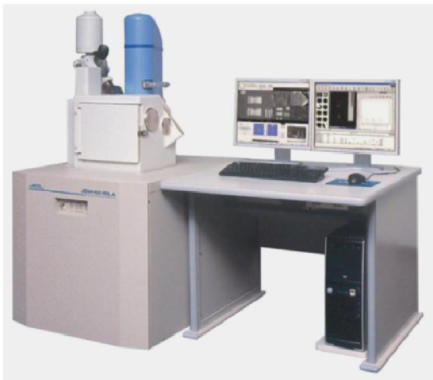
Рисунок 22 – Сканирующий электронный микроскоп «Jeol» «JSM-6610LV»
