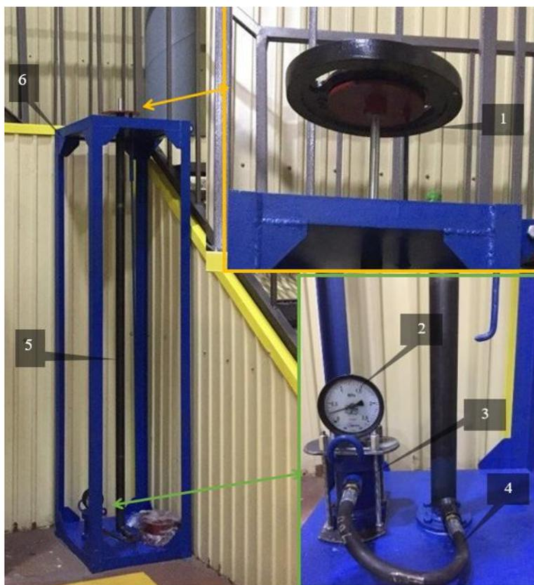
1 – груз; 2 – манометр; 3 – герметичный стакан; 4 – гибкий шланг высокого давления; 5 – пневмоцилиндр; 6 – каркас
