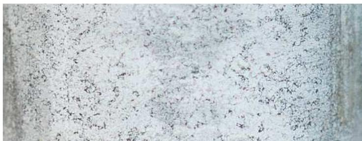
Рисунок 12 – Внешний вид образца сплава АД31 после испытаний при периодическом погружении в 3 % NaCl
