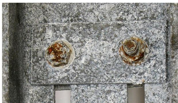
Рисунок 5 – Коррозия стальных болтов, установленных в оцинкованную стальную пластину, после 150 суток в камере влажности
