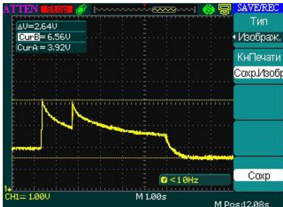
Рисунок 5.7– Осциллограмма изменения давления в рабочем цилиндре при штамповке с поршневым мультипликатором давления, снабженным форкамерой при давлении топливной смеси  $P_c = 0,6$  МПа
