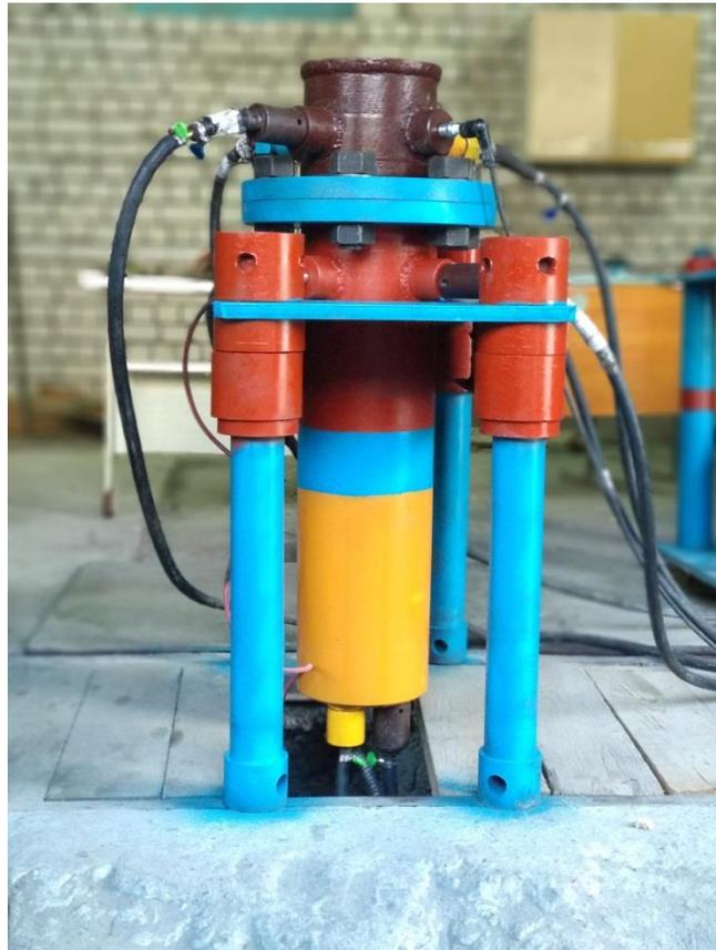
Рисунок 4.8 – Фотография разработанного экспериментального устройства для листовой штамповки с поршневым мультипликатором давления
