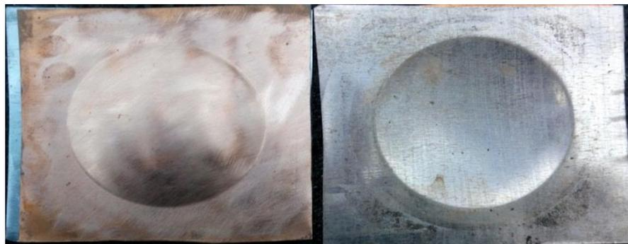
Рисунок 6.3 – Биметаллическое спаянное сферообразное днище
