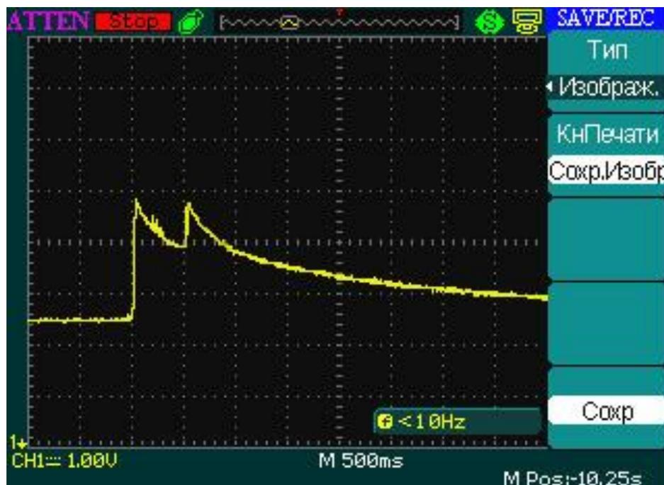
Рисунок 5.8 – Осциллограмма изменения давления в рабочем цилиндре при штамповке с поршневым мультипликатором давления, снабженным форкамерой при давлении топливной смеси  $P_c = 0,7$  МПа.
