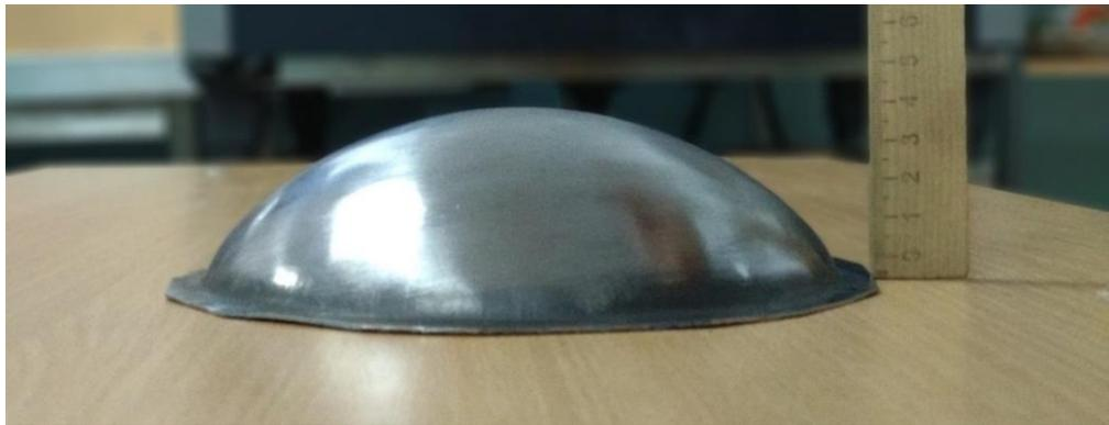
Рисунок 5.12 – Сферообразное днище глубиной 38 мм
