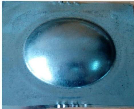
Рисунок 6.1 – Биметаллическое спаянное сферообразное днище (оцинкованная сталь + жесть пищевая).
