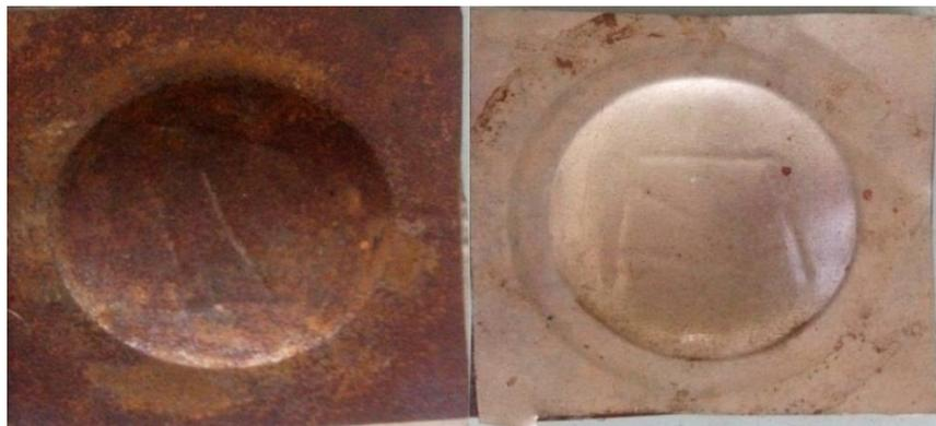
Рисунок 6.2 – Биметаллическое спаянное сферообразное днище
