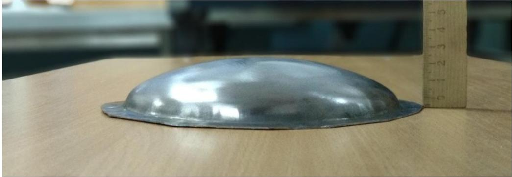
Рисунок 5.11 – Сферообразное днище глубиной 25 мм
