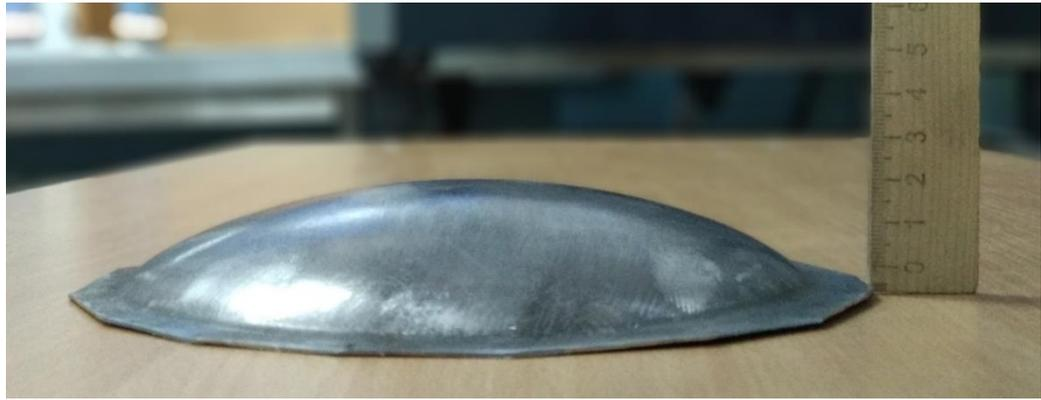
Рисунок 5.10 – Сферообразное днище глубиной 19 мм
