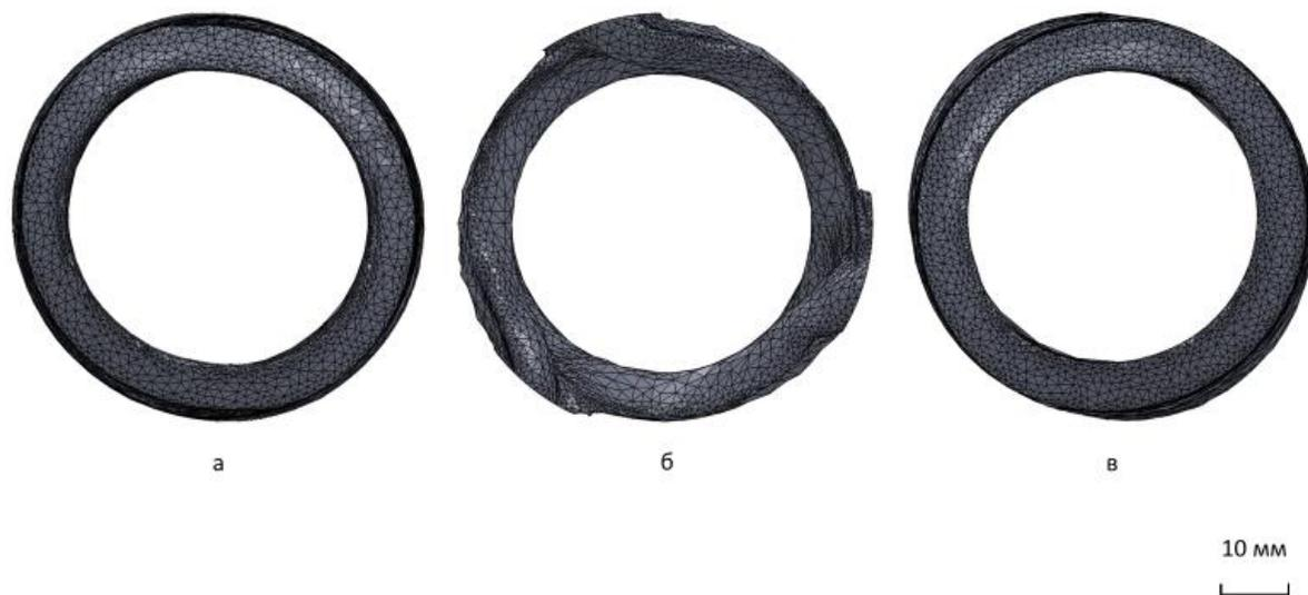
Рисунок 15. Вид гильз со стороны торца после прошивки в двухвалковом стане (а), трёхвалковом стане (б) и стане без направляющего инструмента (в)
