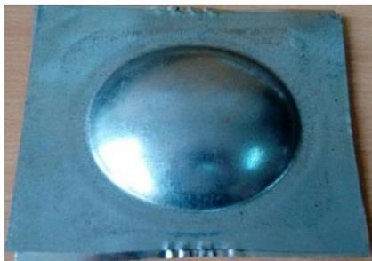
Рисунок 18 – Биметаллическое спаянное сферообразное днище (оцинкованная сталь + жесть пищевая).
