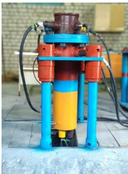
Рисунок 12 – Фотография разработанного экспериментального устройства для листовой штамповки с поршневым мультипликатором давления
