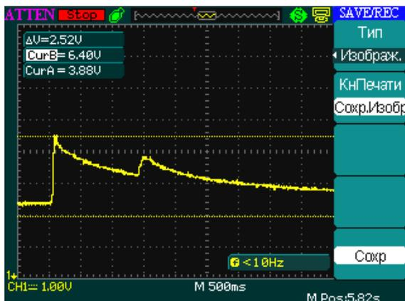
Рисунок 15 – Осциллограмма изменения давления в рабочем цилиндре при штамповке с поршневым мультипликатором давления при давлении топливной смеси  $P_c = 0,6 \text{ МПа}$
