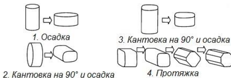
Рисунок 7 – Схема процесса мультиосевой деформации
