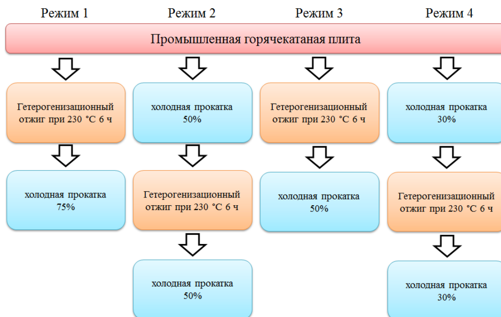
Рисунок 21 – Технологии получения листовых образцов толщиной 1, 3 и 5 мм
