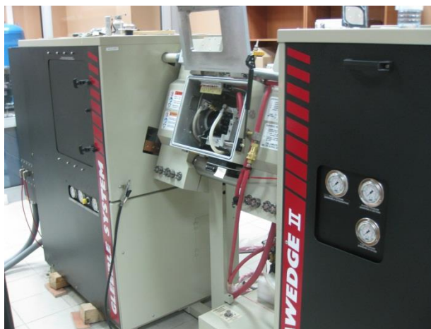
Рисунок 5 – Комплекс физического моделирования Gleeble System 3800
