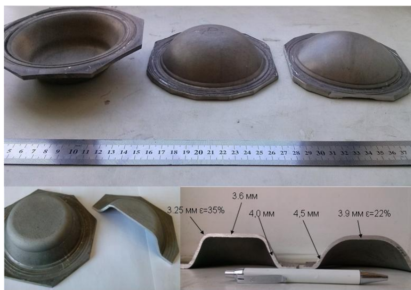
Рисунок 28 – Детали куполообразной формы из 5 мм листа сплава 1565, полученного методом сверхпластической формовки
