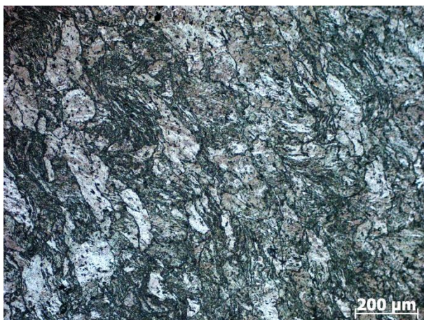
Рисунок 39 – Микроструктура срединного сечения после двух и четырёх циклов осадки при 300 °С
