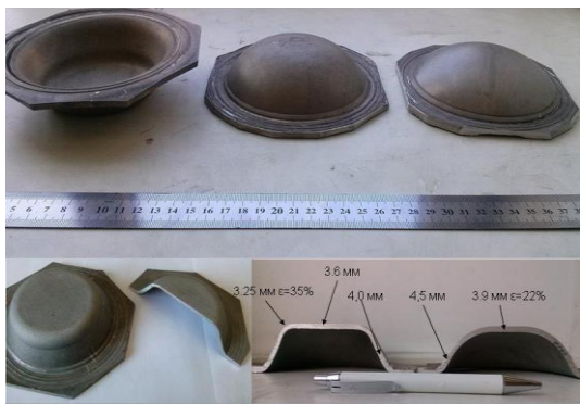
Рис. 6 – Детали куполообразной формы из 5 мм листа сплава 1565ч, полученного методом сверхпластической формовки
