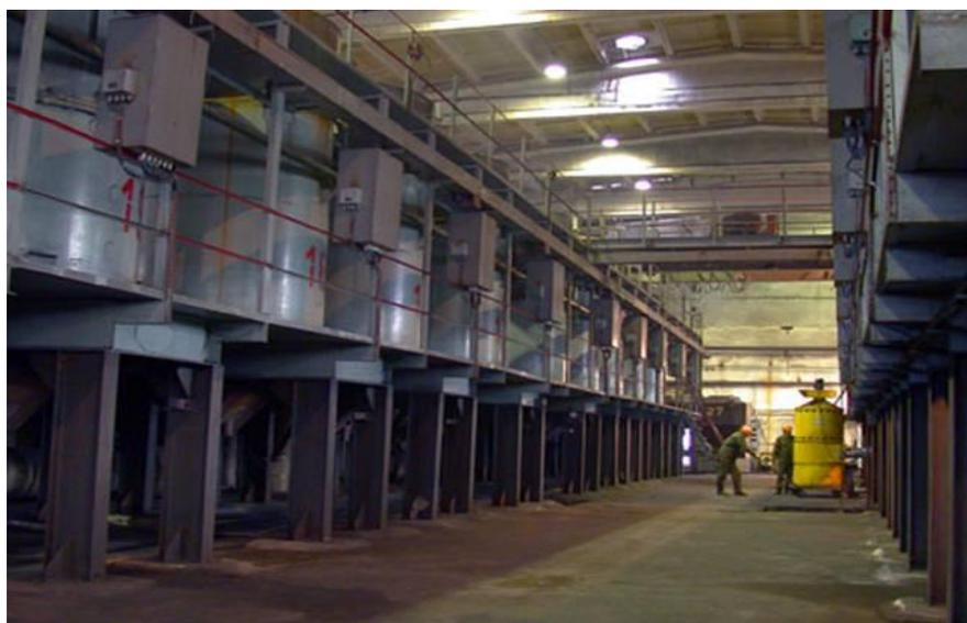
*Рис.3.7. - Действующее производство среднетемпературного кокса, блок газификаторов*
