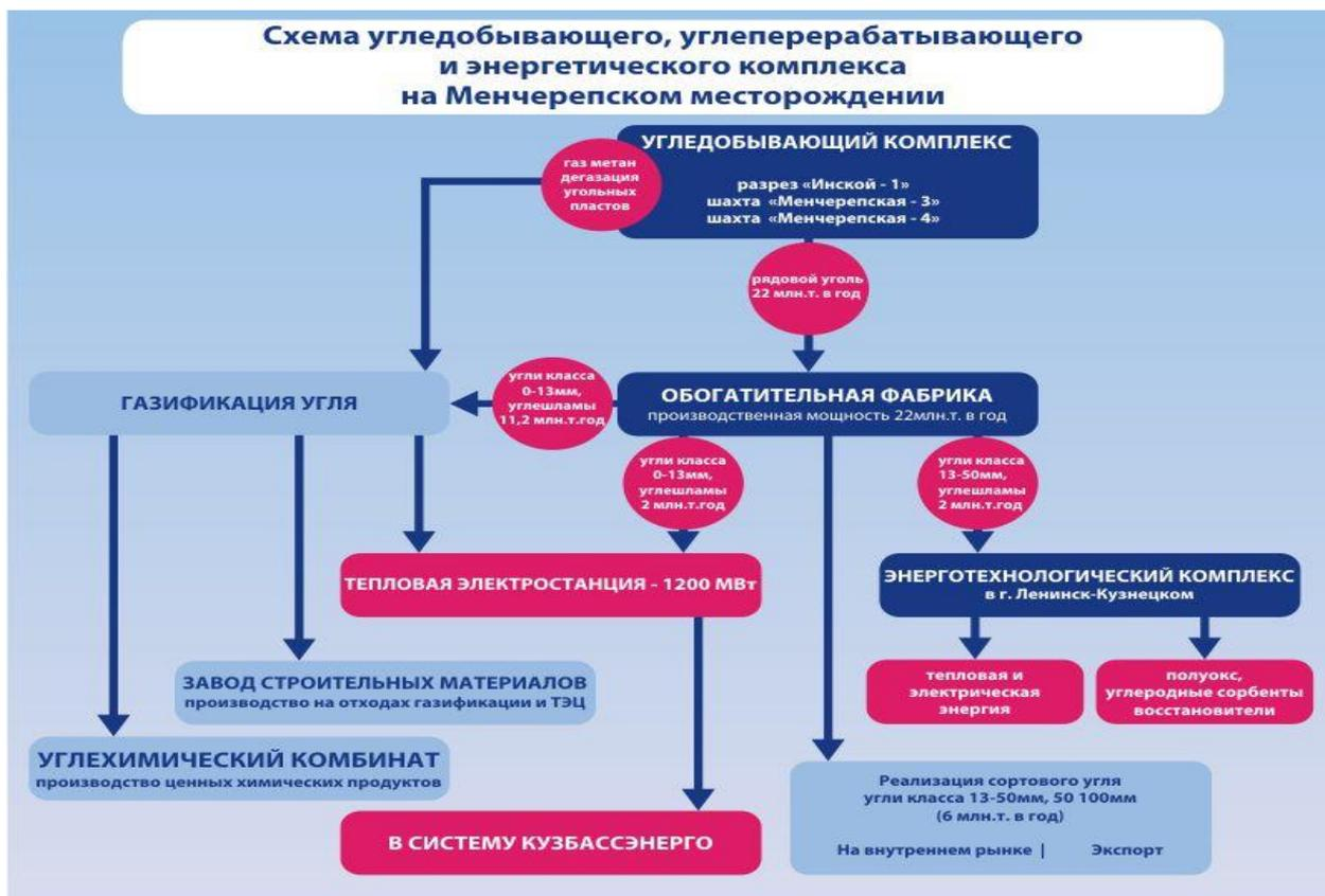
*Рис.3.17. – Проектная функциональная структура углеэнергетического Менчерепского кластера*
