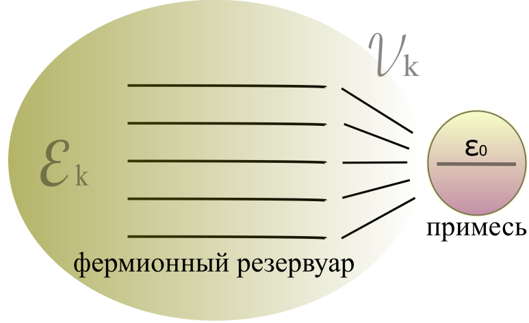
Рисунок 1.3 — Схематическое представление одноорбитальной примесной модели Андерсона. Здесь \epsilon_k – энергетические уровни фермионного резервуара, \epsilon_0 – энергия орбитали примеси, \mathcal{V}_k – параметр гибридизации, характеризующий переход электрона между примесью и эффективными уровнями резервуара.
