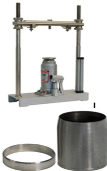
Рисунок 3.1 — Рама с гидравлическим домкратом и рабочие кольца для вырезания образцов горной породы
