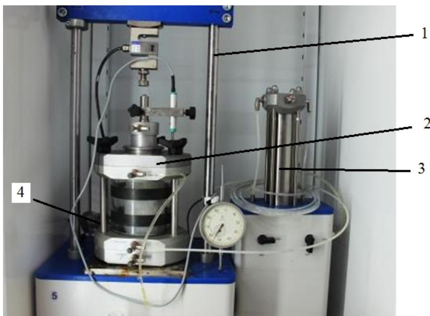
Рисунок 3.3 — Общий вид установки трехосного сжатия испытательного комплекса «АСИС-2»
