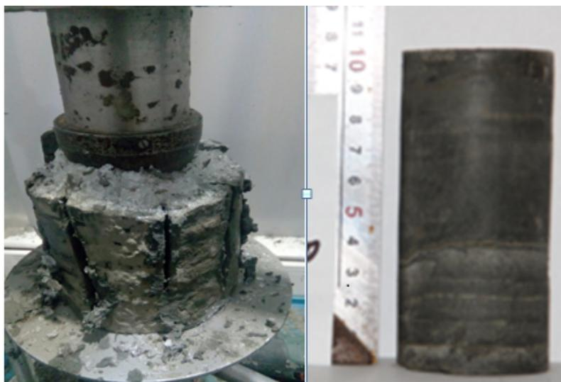
Рисунок 3.2 — Пример изготовления образца из керна материала методом вырезания режущим кольцом
