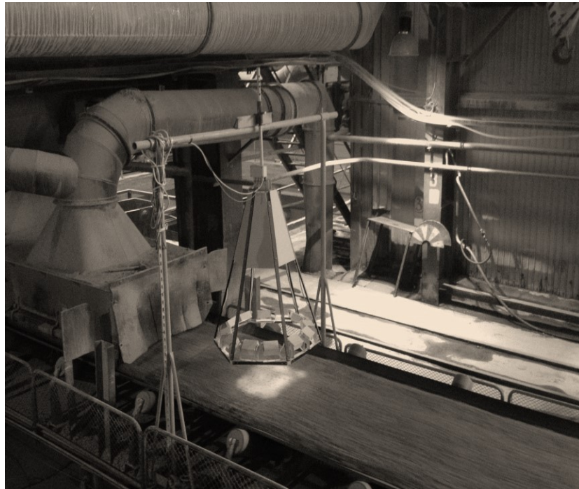
Рисунок 5.1. - Схема и общий вид установки видеодатчика системы «ГРАНИКС» над конвейером: 1, 5 - дробилки; 2, 6 - грохоты; 3- конвейер; 4, 7 – устройства съема видеоизображений; 8 – процессор; 9 - барабанная мельница; 10 – сервер
