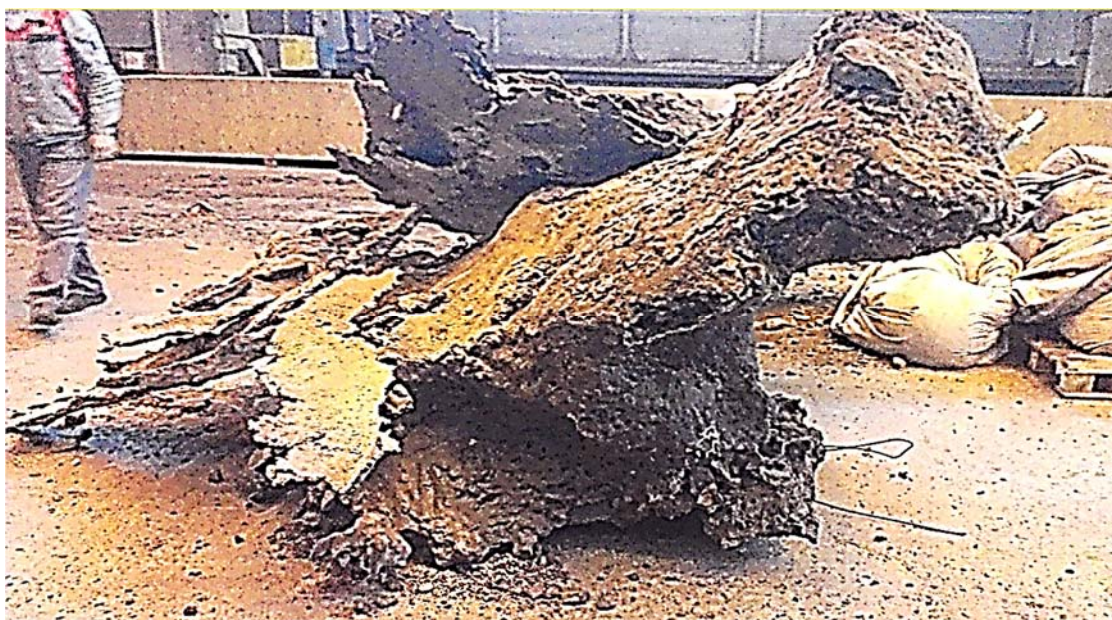
Рис.3.37. Тугоплавкая глыба, извлеченная из ДСП после окончания кампании футеровки печи.
