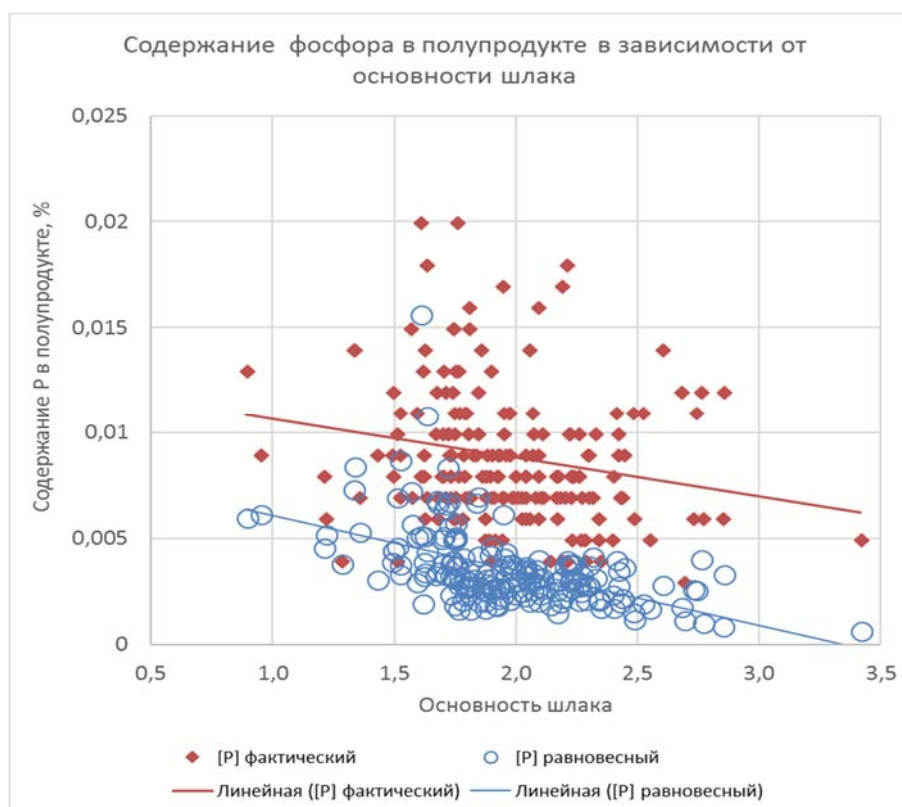
Рис. 3.54. Влияние основности шлака на содержание фосфора в стали.
