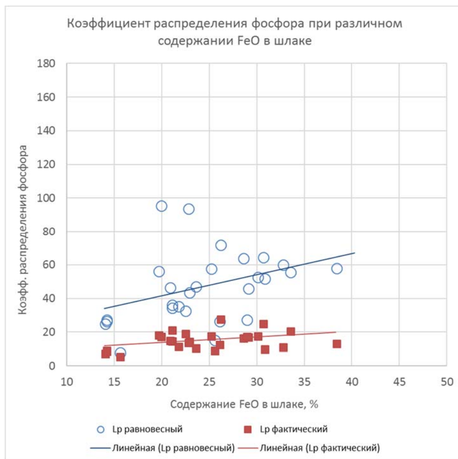
Рис. 3.56. Коэффициент распределения фосфора между шлаком и металлом при изменении содержания FeO в шлаке (при работе на 100 % ломе в завалке).
