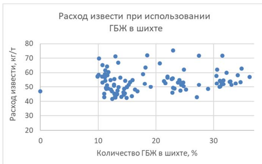
Рис. 3.18. Удельный расход извести в зависимости от доли ГБЖ в шихте.
