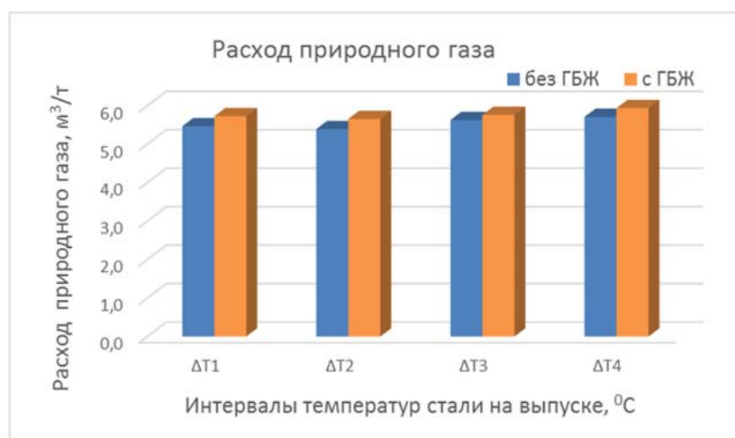
Рис. 3.22. Удельный расход природного газа (средний) при разных интервалах температур стали на выпуске.
