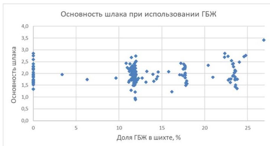
Рис. 3.48. Основность шлака в зависимости от доли ГБЖ в шихте.
