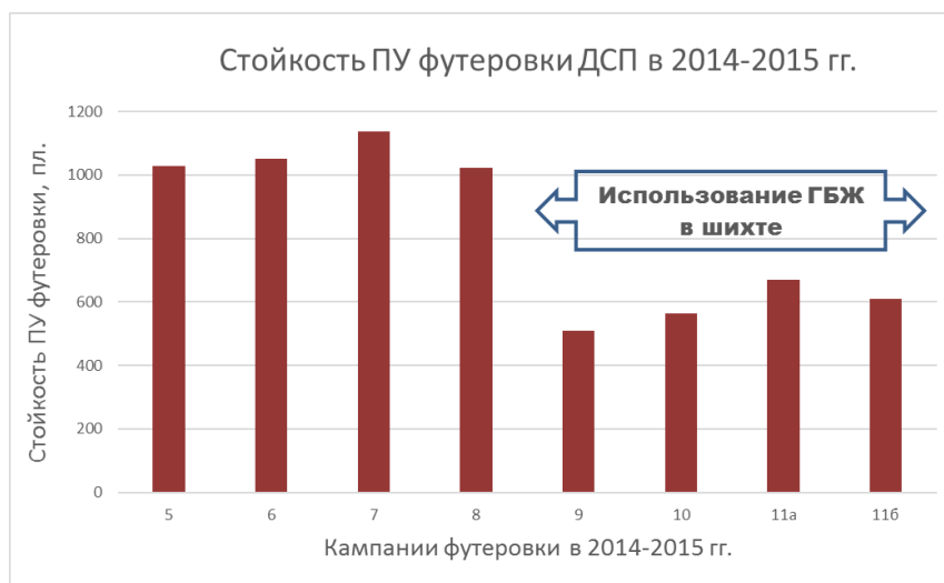
Рис. 4.1. Стойкость ПУ футеровки ДСП-150 ТАГМЕТ при использовании 100% металлического лома и добавки ГБЖ в металлошихту.
