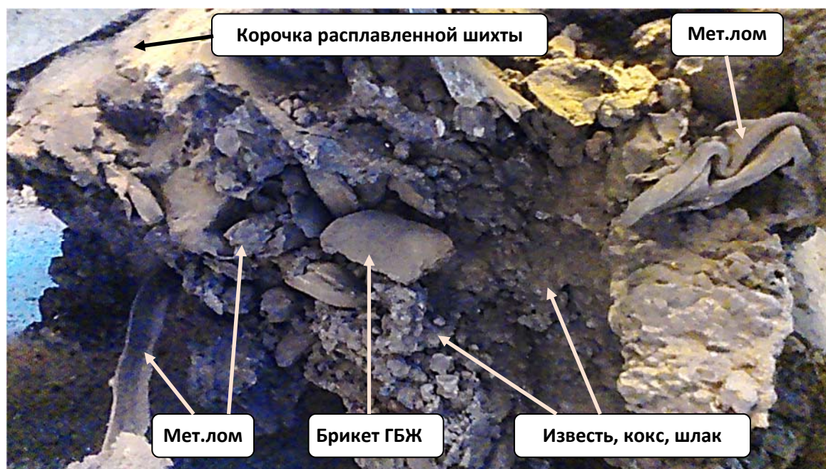
Рис.3.38. Компоненты конгломерата, извлеченного из ДСП после окончания кампании футеровки печи.
