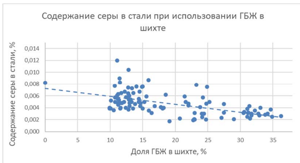
Рис. 3.61. Содержание серы в стали в зависимости от доли ГБЖ в шихте (107 плавов).
