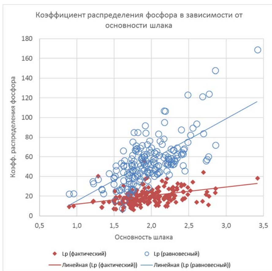
Рис. 3.55. Коэффициент распределения фосфора между шлаком и металлом при изменении основности шлака.
