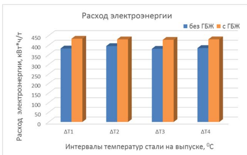
Рис. 3.20. Удельный расход электроэнергии (средний) при разных интервалах температур стали на выпуске.
