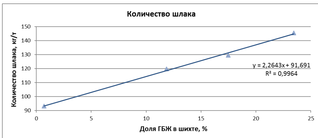
Рис. 4.16. Удельное количество шлака при увеличении добавки ГБЖ.
