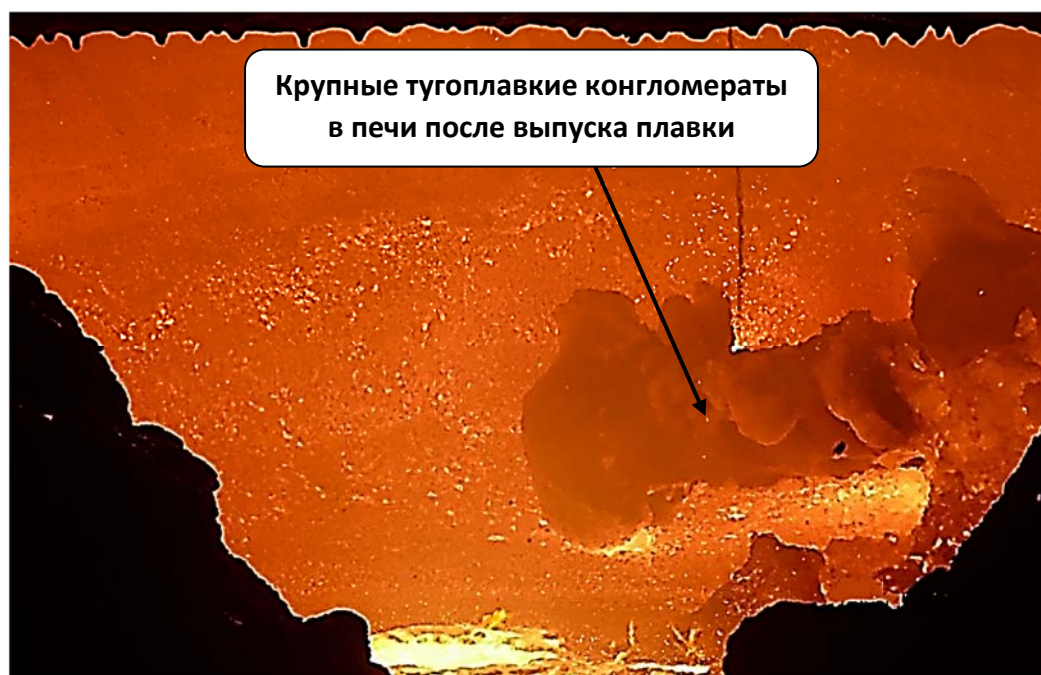
Рис. 3.36. Образование крупных конгломератов из ГБЖ после выпуска плавки из ДСП.
