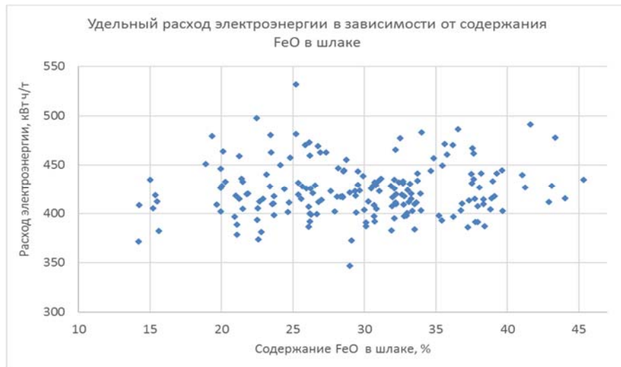
Рис. 3.6. Удельный расход электроэнергии в зависимости от содержания FeO в шлаке.
