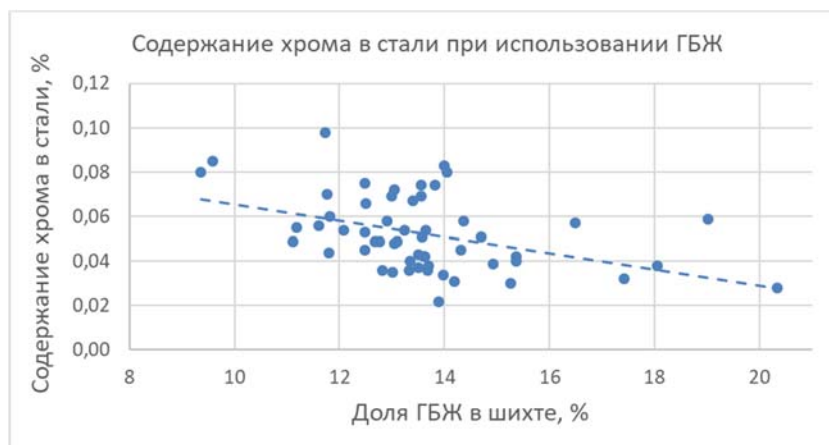
Рис. 3.71. Содержание хрома в стали в зависимости от доли ГБЖ в шихте (52 плавки).
