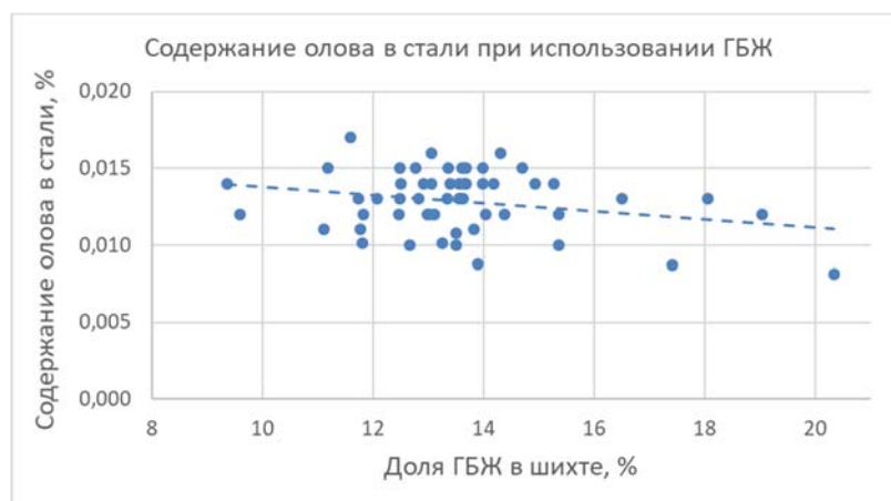
Рис. 3.70. Содержание олова в стали в зависимости от доли ГБЖ в шихте (52 плавки).
