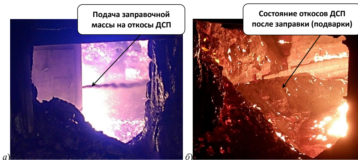
Рис. 2.7. Подварка (заправка) откосов и подины ДСП-150 после выпуска плавки (вид через рабочее окно).
