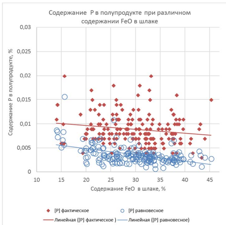
Рис. 3.50. Влияние окисленности шлака на содержание фосфора в стали.
