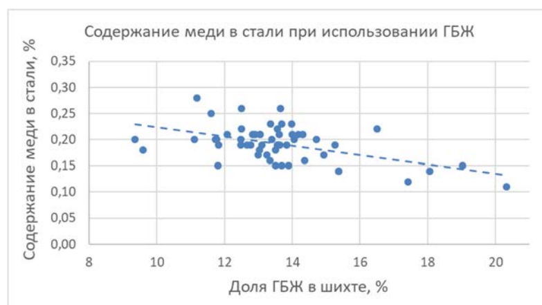
Рис. 3.69. Содержание меди в стали в зависимости от доли ГБЖ в шихте (52 плавки).
