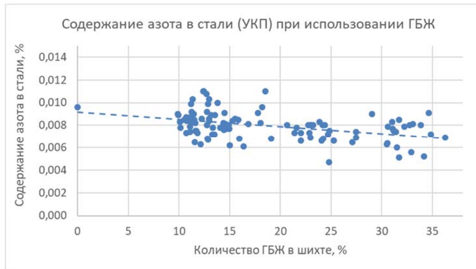
Рис. 3.60. Содержание азота в стали в зависимости от доли ГБЖ в шихте (107 плавов).
