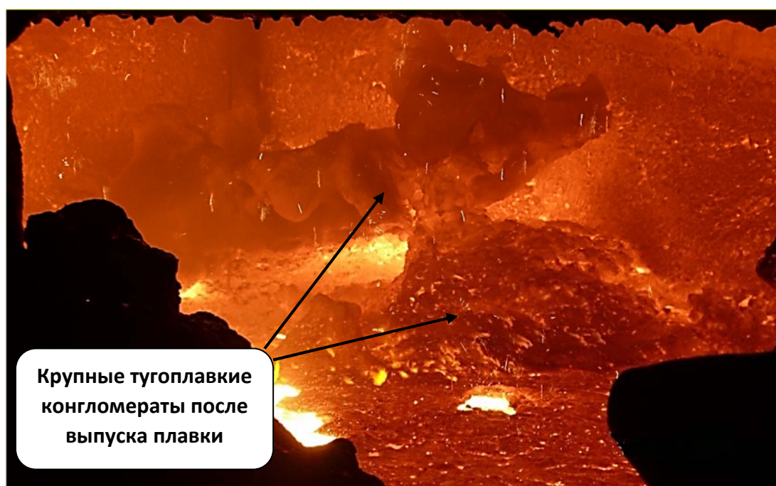
Рис.3.35. Образование крупных конгломератов из ГБЖ после выпуска плавки из ДСП.
