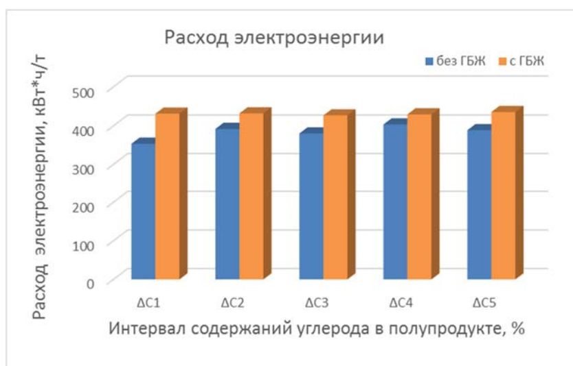
Рис. 3.25. Удельный расход электроэнергии (средний) при разных интервалах содержаний углерода в полупродукте.
