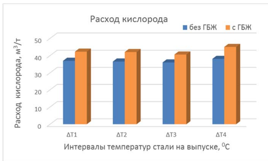
Рис. 3.21. Удельный расход кислорода (средний) при разных интервалах температур стали на выпуске.
