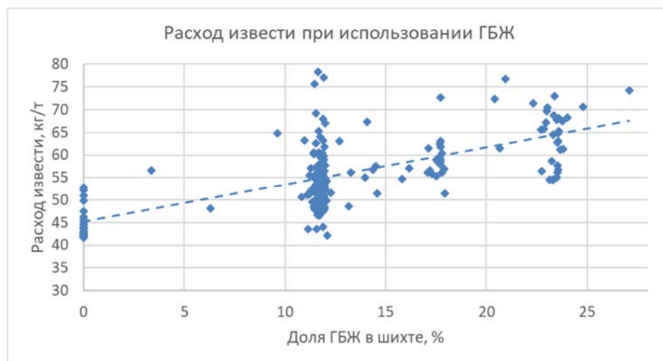
Рис. 3.10. Удельный расход извести в зависимости от доли ГБЖ в шихте.
