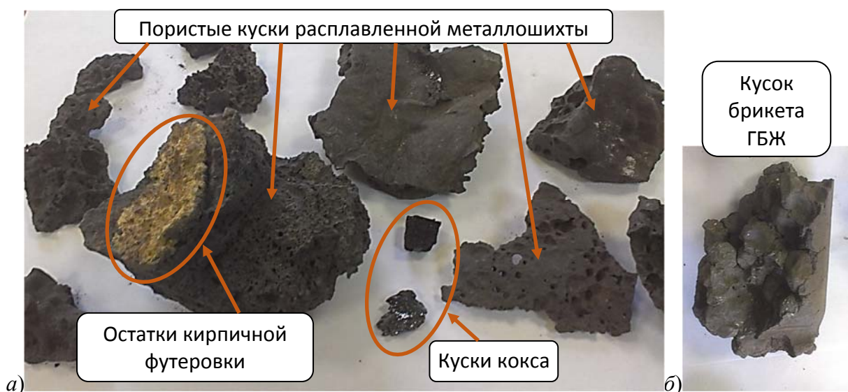
Рис.3.39. Компоненты тугоплавкой глыбы, извлеченной из ДСП после окончания кампании футеровки печи.
