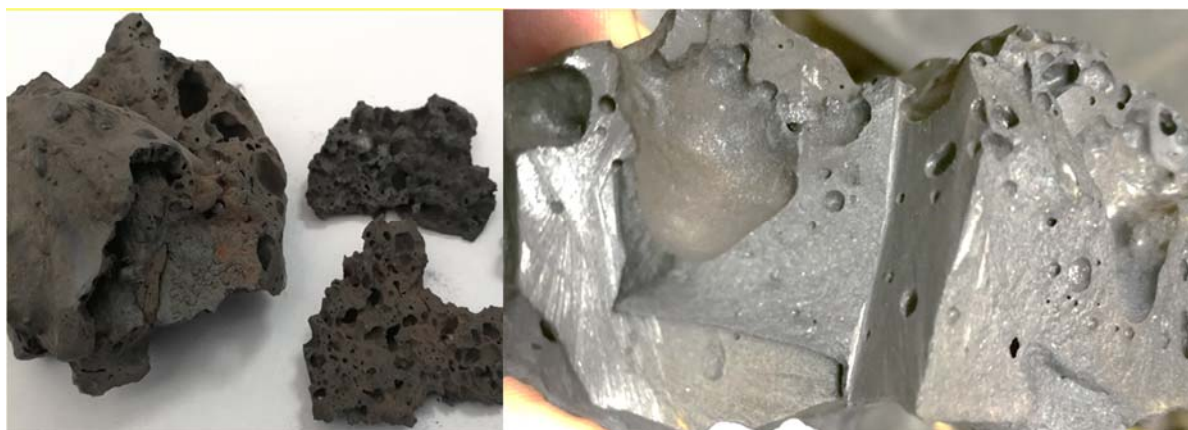
Рис.3.42. Образцы наружной оболочки конгломерата, извлеченного из ДСП после окончания кампании футеровки печи.
