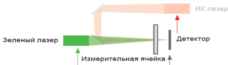
Рисунок 17 – Принципиальная схема измерения размера частиц методом лазерной дифракции
