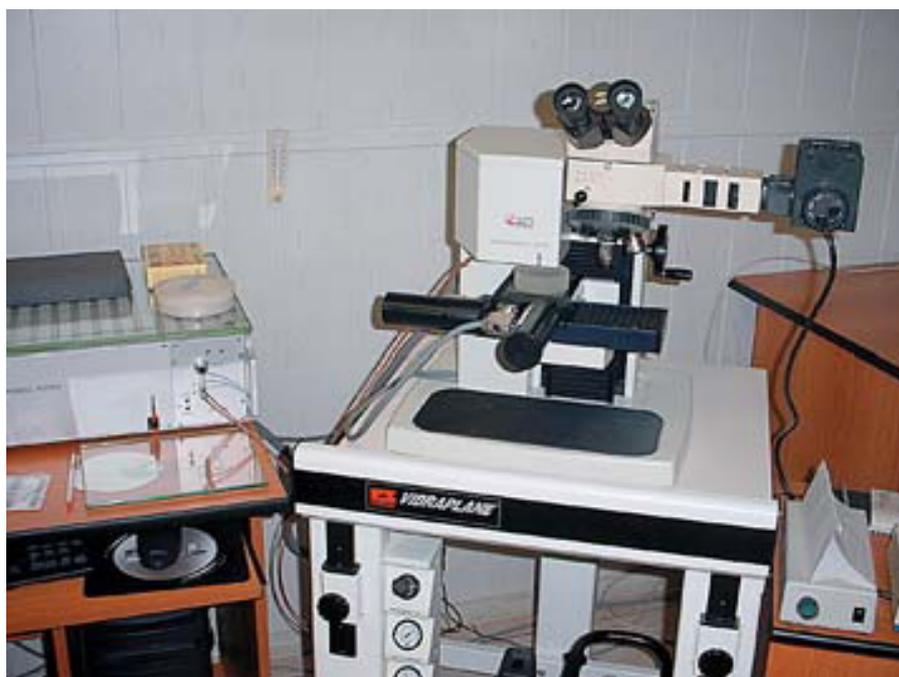
Рисунок 21 – Внешний вид нанотвердомера Nano-Hardness Tester
