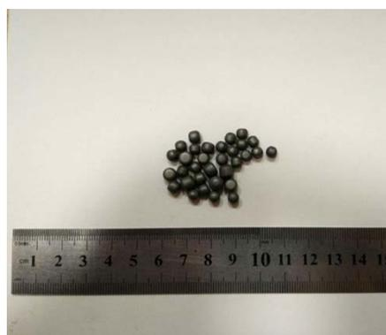
Рисунок 15 – Стальной барабан лабораторной мельницы и размольные твердосплавные тела
