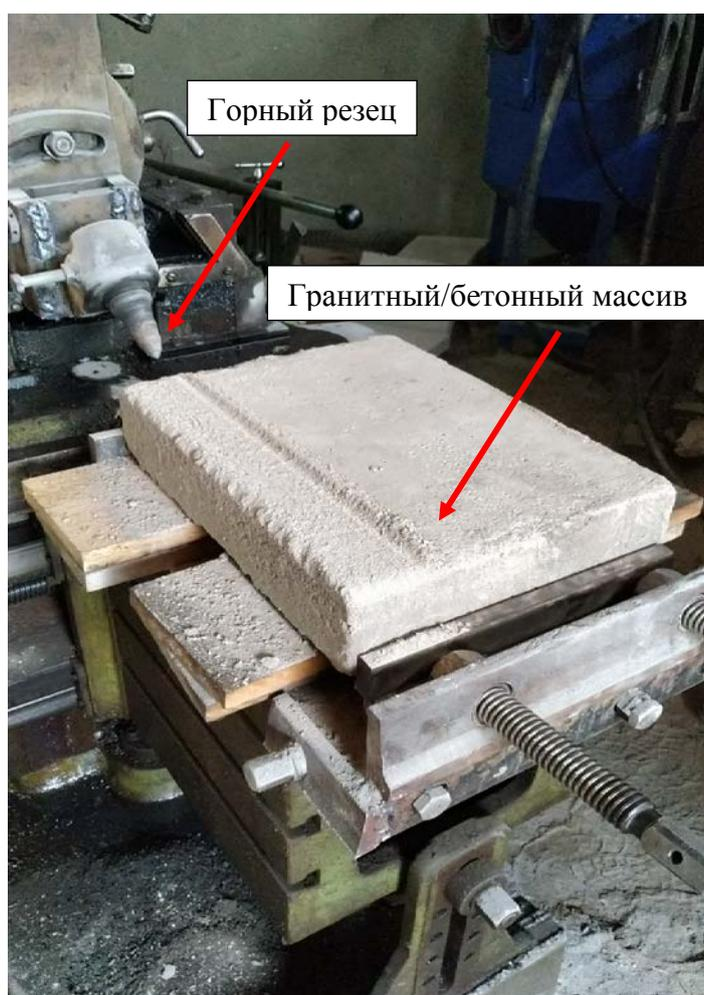
Рисунок 23 – Внешний вид испытательного стенда по разрушению гранита/бетона
