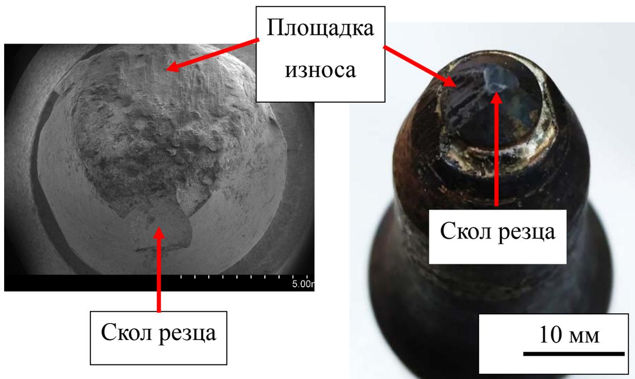
Рисунок 68 – Поверхность износа горного инструмента, оснащенного стандартным твердым сплавом ВК6-В после резки гранита
