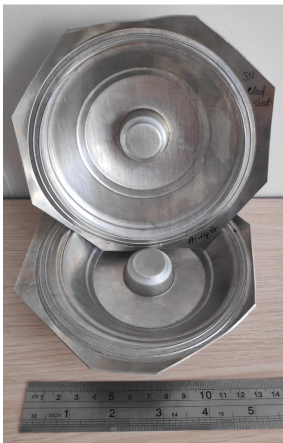
Рис.60 - Внешний вид модельных деталей, полученных сверхпластической формовкой из высокопрочного листа, плакированного сплавами Al-3Mg-0,25Zr и Al-3Mg-0,25Er-0,25Zr.
