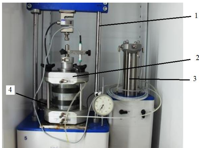
Рисунок 4 — Общий вид установки трехосного сжатия испытательного комплекса «АСИС-2»
