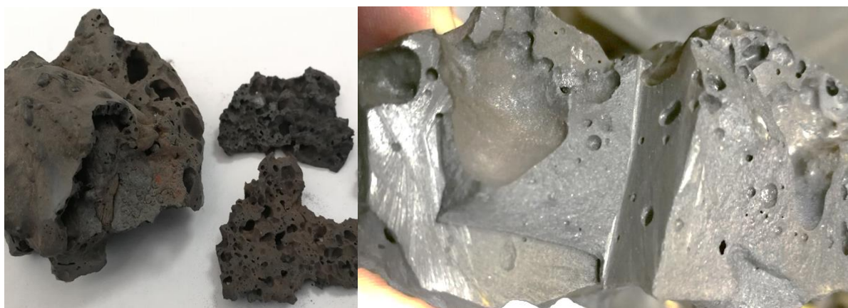
Рис. 3. Образцы наружной оболочки конгломерата, извлеченного из ДСП после окончания кампании футеровки печи.
