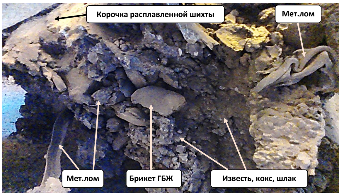
Рис. 2. Компоненты конгломерата, извлеченного из ДСП после окончания кампании футеровки печи.
