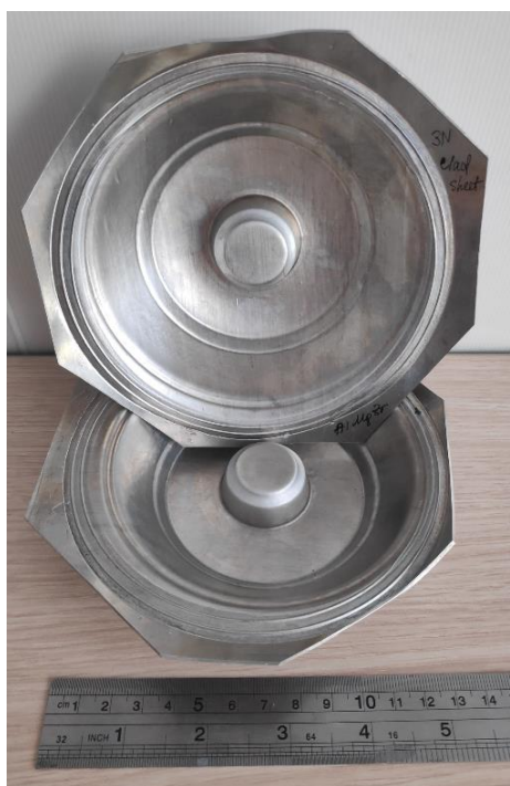
Рис.22 - Внешний вид модельных деталей, полученных сверхпластической формовкой из высокопрочного листа, плакированного сплавами Al-3Mg-0,25Zr и Al-3Mg-0,25Er-0,25Zr.
