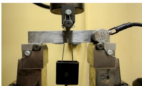
Рисунок 1 – Схема испытания для оценки КРТ
