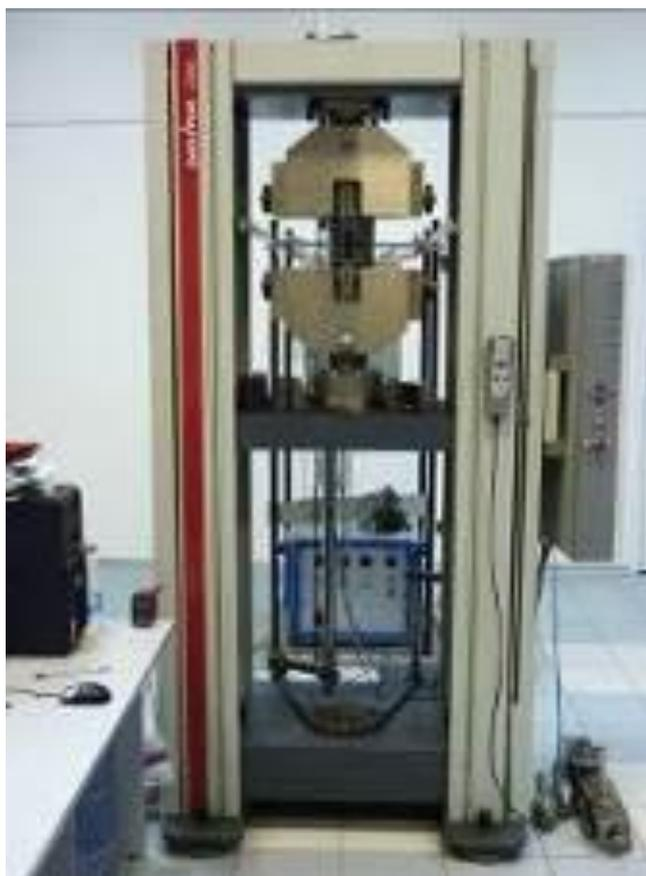
Рисунок 2.13. Универсальная машина для механических испытаний Zwick Z250.
