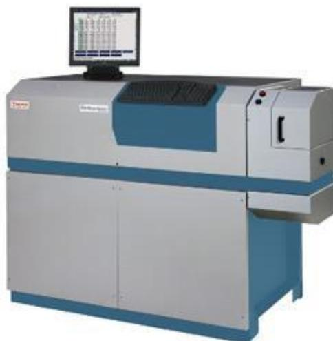
Рисунок 2.8 - Оптико-эмиссионный спектрометр ARL 4460.
