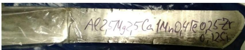
Рисунок 6.2. Слиток и прокат экспериментального сплава  $Al_{2,5}Mg_{2,5}Ca$ .
