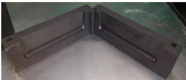
Рисунок 2.2. Фотография разъемной формы из графита марки МПГ7, предназначенной для получения заготовок для выточки образцов по ГОСТ 1583-93.
