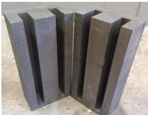
Рисунок 2.1. Фотография разъемной формы из графита марки МПГ7, предназначенной для получения слитков с номинальными размерами 15x60x180 мм.
