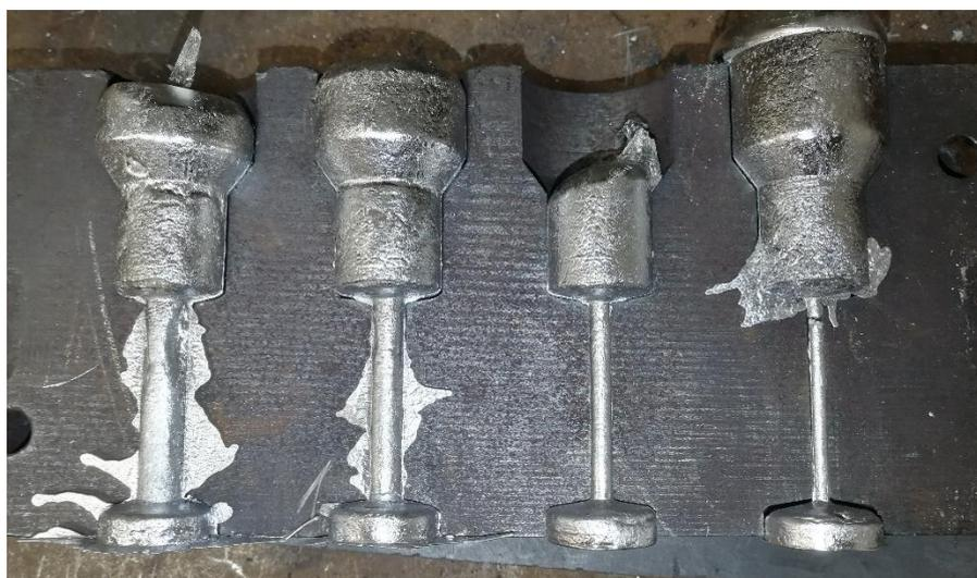
Рисунок 4.6. Отлитые образцы «карандашной» пробы на горячеломкость сплава Al1,5Ca2Mn.
