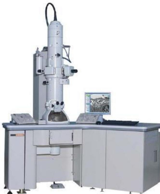
Рисунок 2.21. Просвечивающий электронный микроскоп JEOL JEM 1400.
