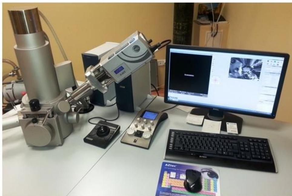
Рисунок 2.20. Сканирующий электронный микроскоп TESCAN VEGA 3 SBH.
