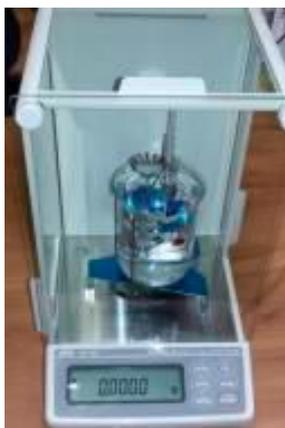
Рисунок 2.15. Аналитические весы AND HR-202i с установленным комплектом для определения плотности методом гидростатического взвешивания.
