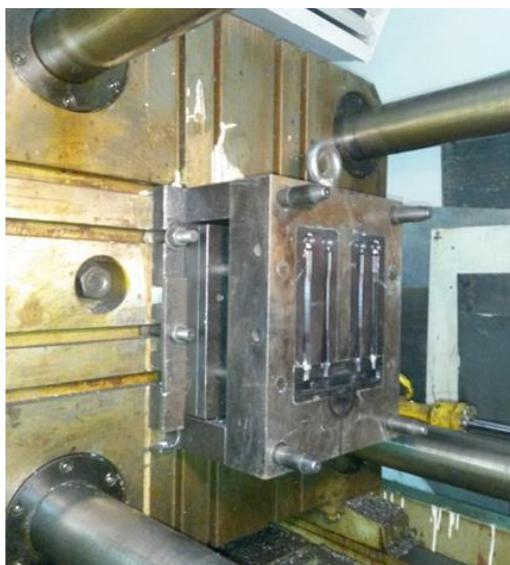
Рисунок 2.3. Фотография пресс-формы машины литья под давлением.
