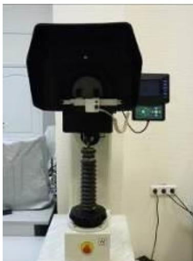
Рисунок 2.14 – Универсальный твердомер Wilson Wolpert 930 M.
