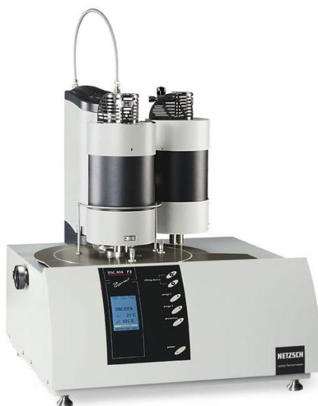
Рисунок 2.17. Дифференциальный сканирующий калориметр DSC 404 C Pegasus.
