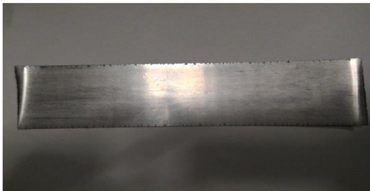
Рисунок 6.1. Холодный прокат экспериментального сплава  $Al_2Ca_1Mn_{0,4}Fe$ .
