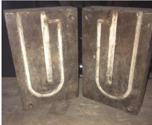
Рисунок 2.11. Комплексная U-образная проба на жидкотекучесть.
