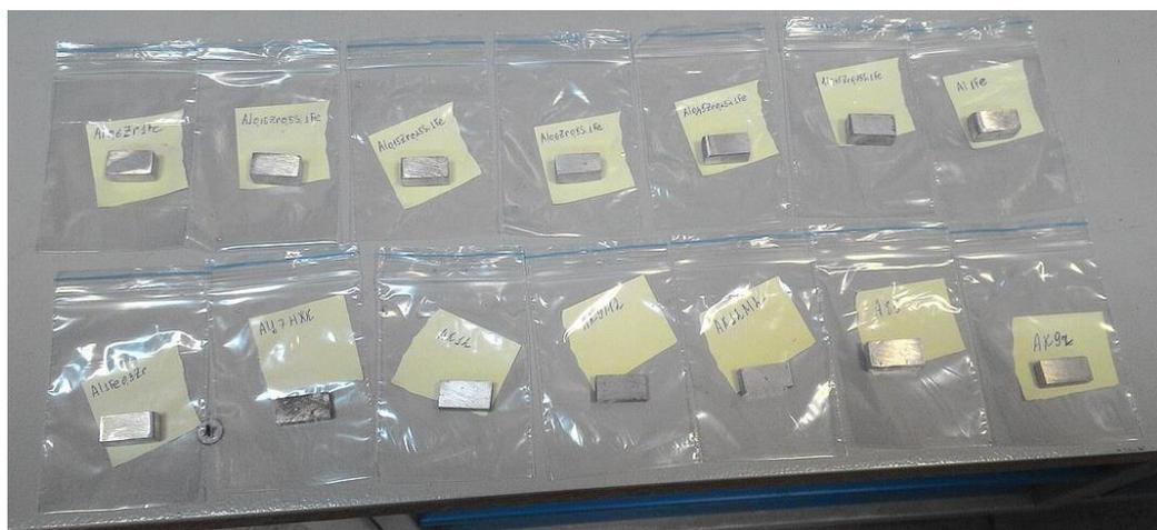
Рисунок 2.18. Образцы для проведения ускоренных коррозионных испытаний.
