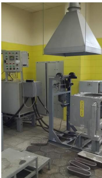
Рисунок 2.1 – Установка индукционная плавильная УИП – 100 - 2,4 - 0,07 «РЭЛТЕК»
