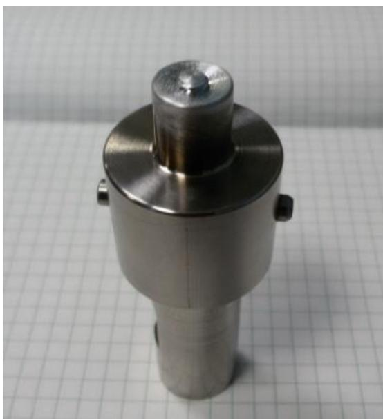
Рисунок 5.31 - Шпиндель использованный для сварки трением с перемешиванием
