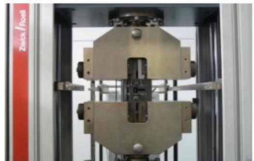
а - твердомер NEMESIS 9000; б - универсальная испытательная машина (ZwickZ250)
