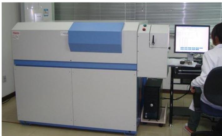
Рисунок 2.2– Оптический эмиссионный спектрометр ARL 3460
