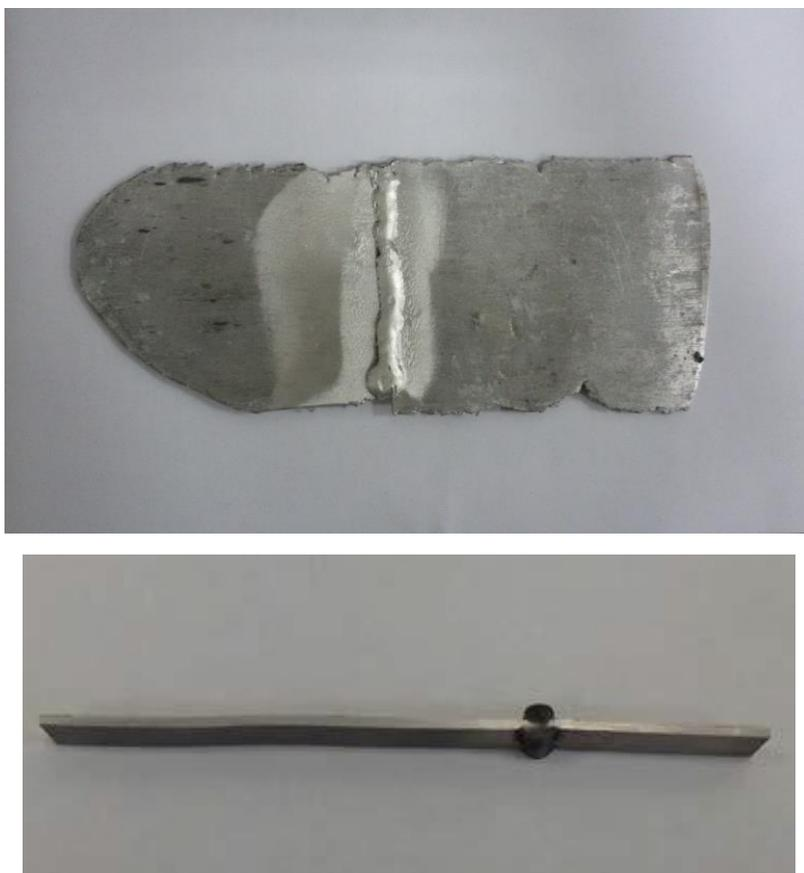
Рисунок 5.28 - Сварной шов полученный аргонно-дуговой сваркой.
