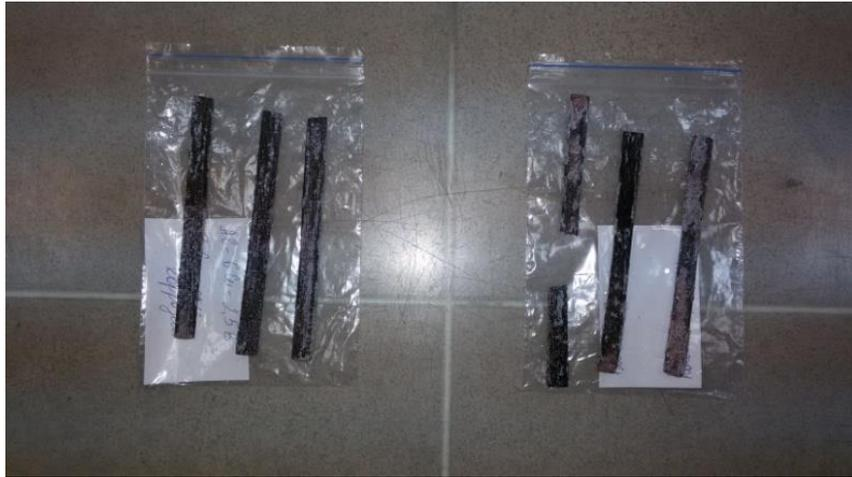
Рисунок 5.27 - Образцы после промывке после испытания на коррозионную стойкость
