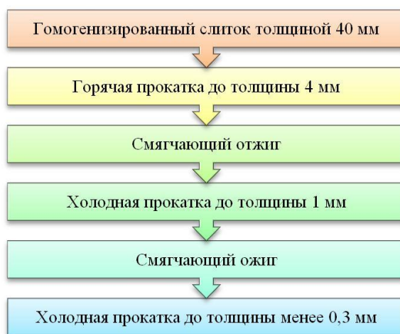
а - схема термо-деформационной обработки слитков боралюминия; б – образец тонколистового проката
