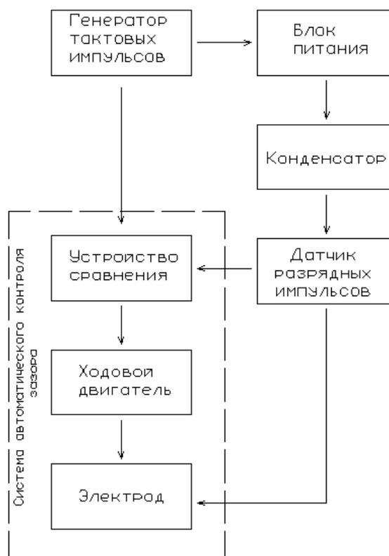
Рисунок 2.8 – Структурная схема системы автоматического контроля межэлектродного зазора
