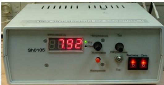
Рисунок 2.3 – Высоковольтный блок питания SH-0105
