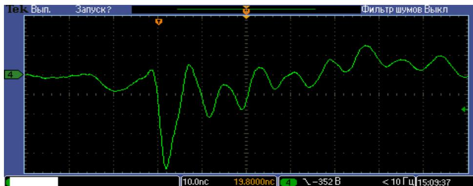
Рисунок 2.27 – Осциллограмма импульса напряжения  $U_{R2}$ , зарегистрированного на измерительном резисторе  $R_2$  при пробое между электродами разрядной камеры КР
