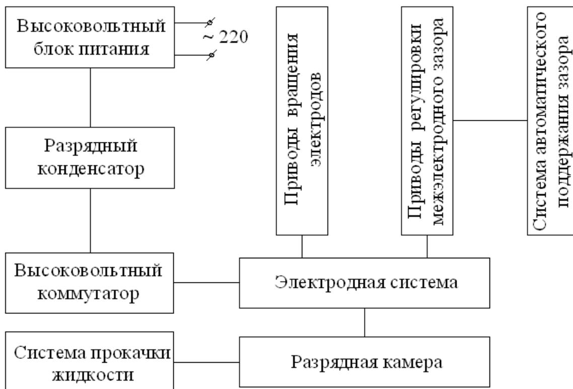
Рисунок 2.2 – Структурная схема установки для генерации наночастиц в жидкой среде электроимпульсным методом
