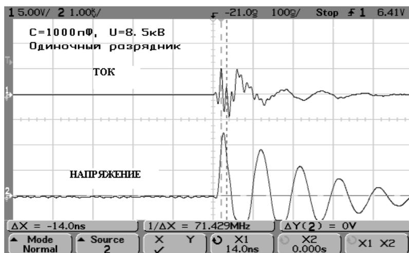
Рисунок 2.15 – Осциллограмма разряда по схеме коммутации с воздушным разрядником
