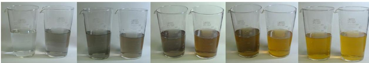
Рисунок 2.21 – Изменение цвета раствора в зависимости от номинала конденсатора (увеличение емкости от 330пФ - 5800пФ)
