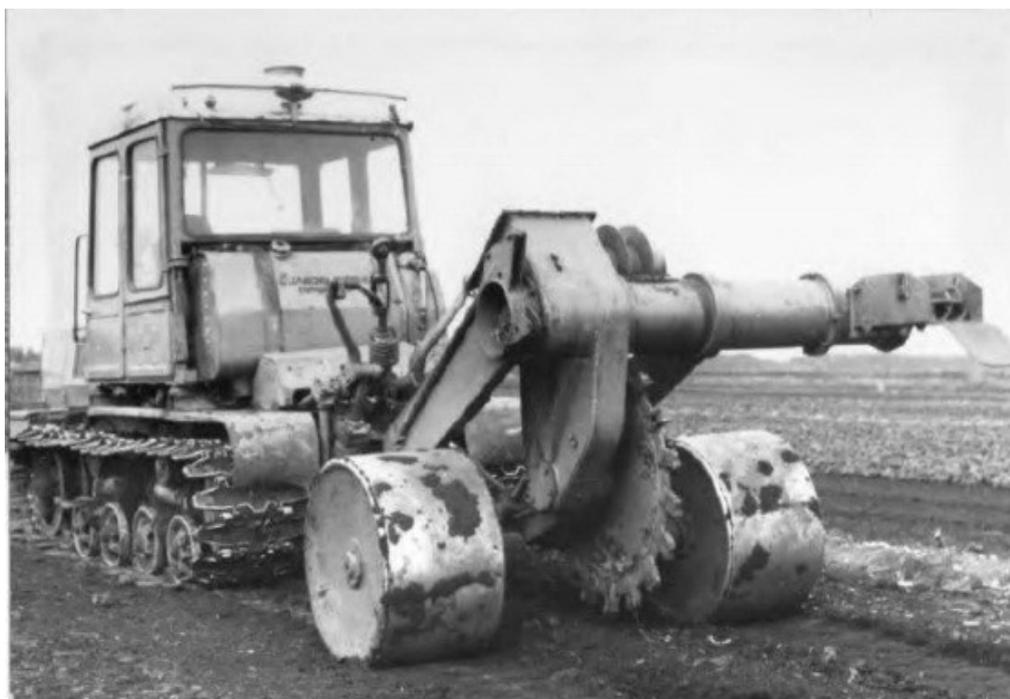
Рисунок 1.15 – Фрезформовочная машина МТК-16 в транспортном положении
