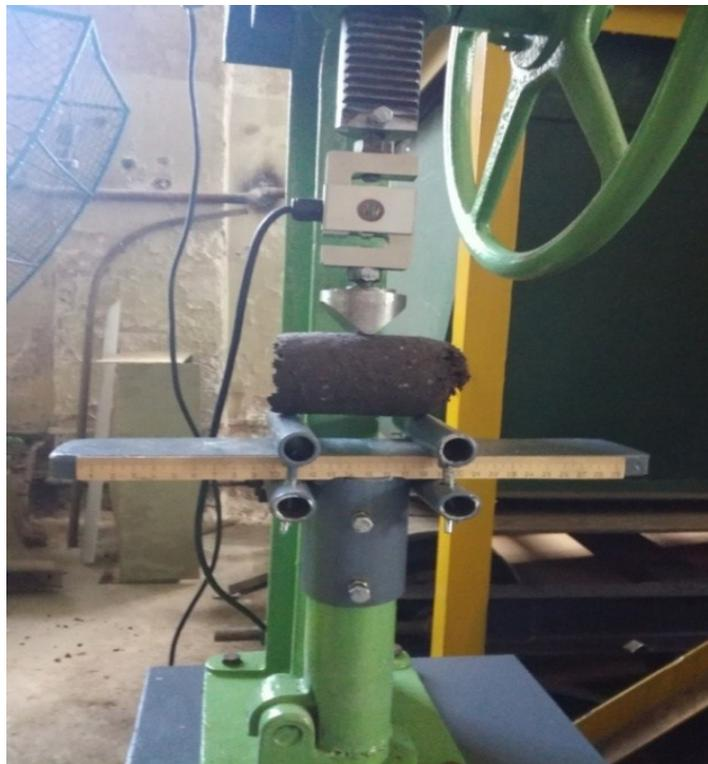
Рисунок 3.21 – Испытание на изгибную прочность образцов кускового торфа круглого сечения
