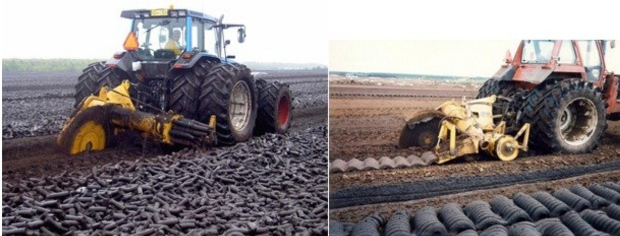
Рисунок 1.1 – Фрезформовочные машины
