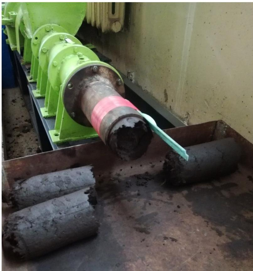
Рисунок 3.6 – Процесс формования торфа
