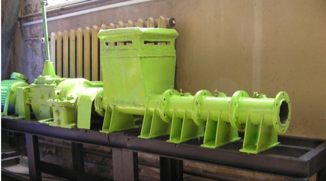
Рисунок 3.2 – Лабораторный шнековый пресс
