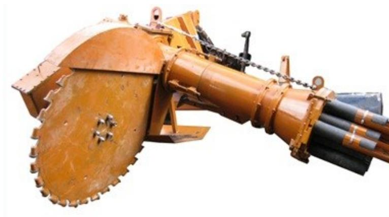
Рисунок 1.21 – Машина для добычи кускового торфа КТД-1
