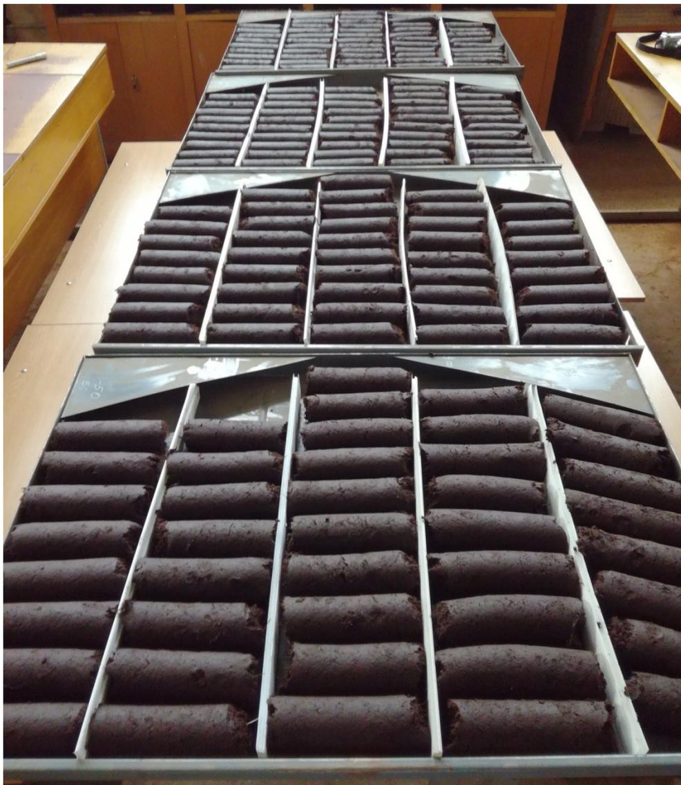
Рисунок 3.7 – Сушка кускового торфа в мягком режиме до достижения среднего равновесного содержания влаги
