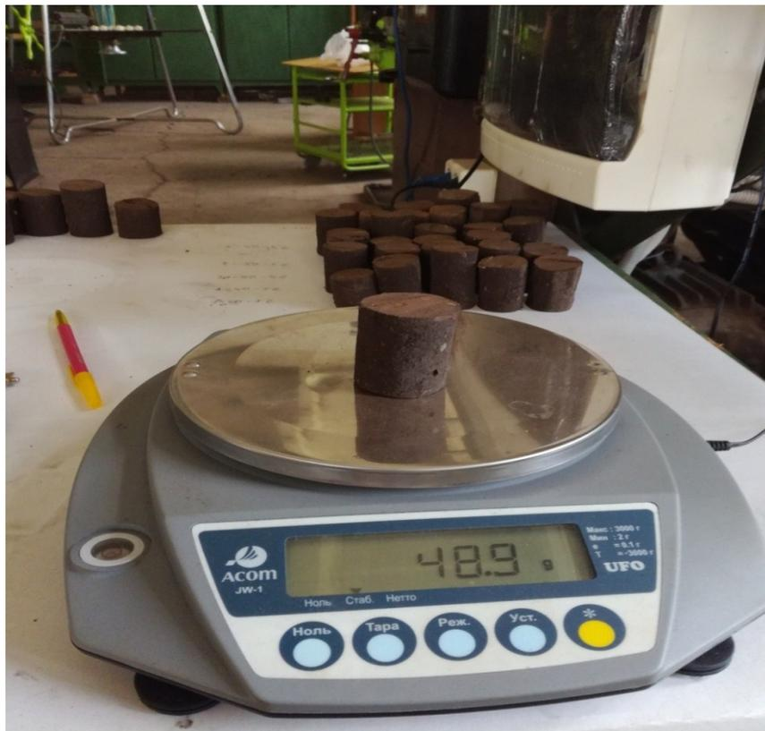
Рисунок 3.15 – Взвешивание образцов кускового торфа на весах АСОМJW-1
