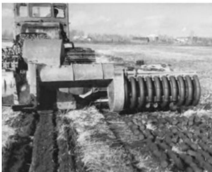
Рисунок 1.25 – Фрезформовочная машина МБТ-600 с торовым формователем
