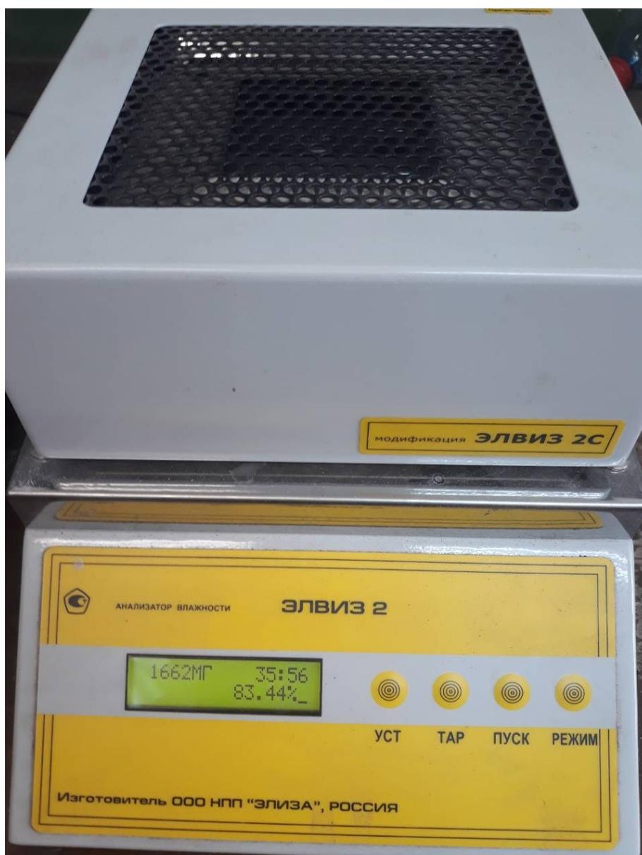
Рисунок 3.1 – Определение влаги исходного сырья с помощью прибора ЭЛВИЗ 2С
