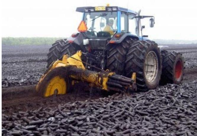
Рисунок 1.22 – Машина для добычи кускового торфа РК-1 (РК-1S)
