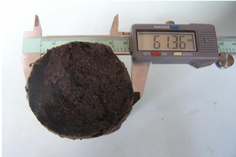
Рисунок 3.14 – Измерений образцов кускового торфа цифровым штангенциркулем ШЦЦ 1-150-0,01
