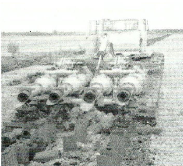
Рисунок 1.24 – Машина для добычи, формования и выстилки кускового торфа
