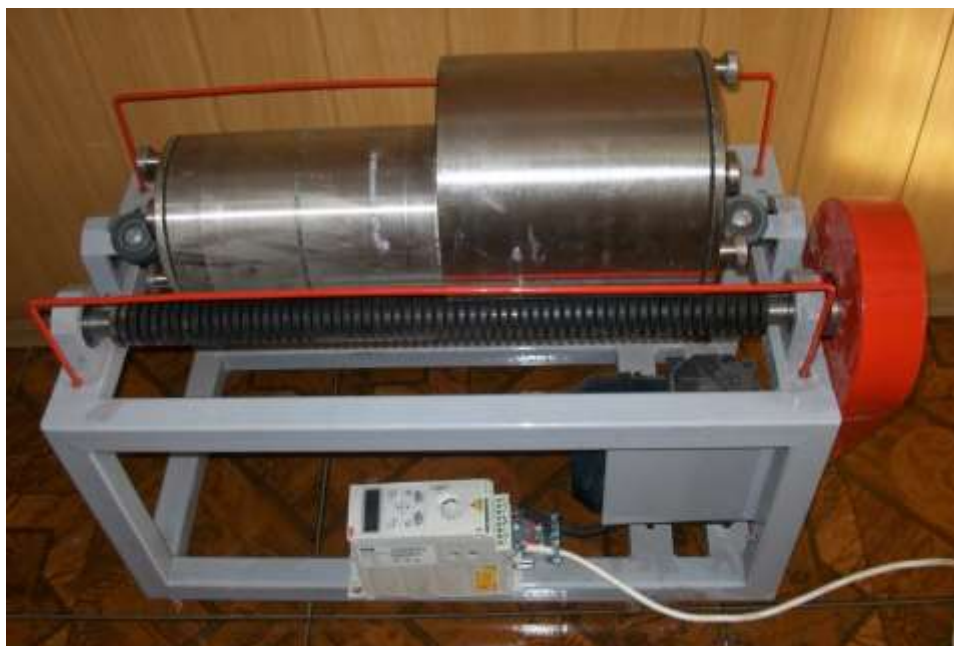
Рисунок 2.4 - Лабораторная мельница на рольганге (с металлическим барабаном и измельчающей средой)
