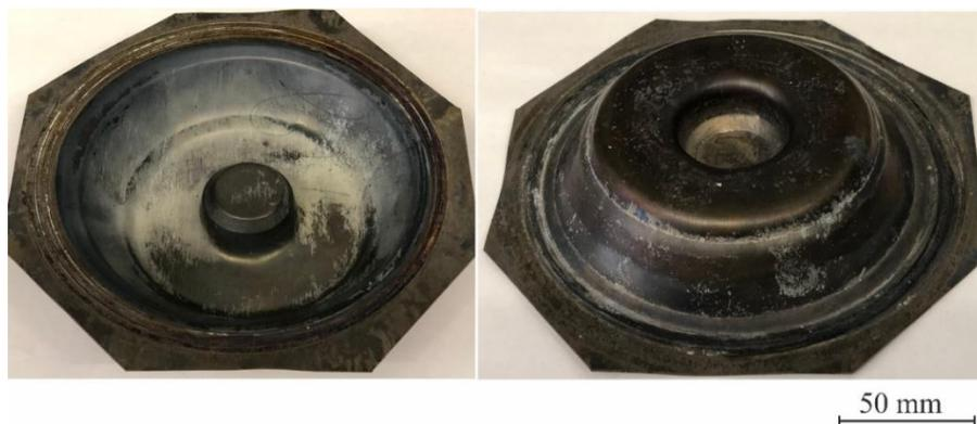
Рисунок 6.17 - Изображения деталей, полученных методом сверхпластической формовки по оптимизированному режиму из листов сплава ВТ14-СТ
