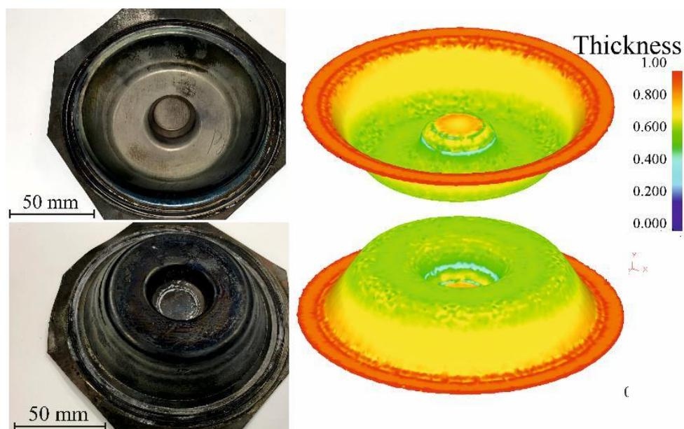
Рисунок 6.8 - Изображения деталей, полученных методом сверхпластической формовки, и результат моделирования МКЭ в программе «Deform 3D» листов СТ сплава ВТ14- при температуре 875 °С
