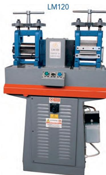
Рис. 3.14. Вид установки Chinetti LM120 для прокатки образцов.
