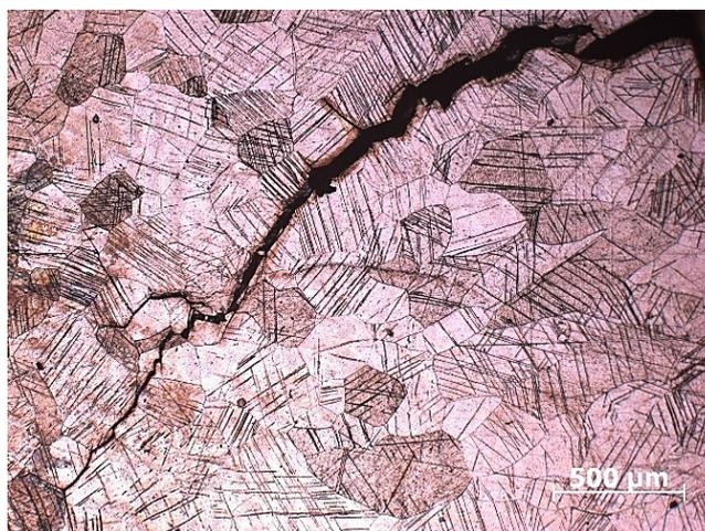
Рис. 3.15. Появление трещин и двойников после холодной деформации.
