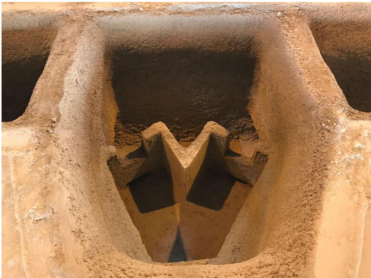
Рисунок 67. Установленное металлоприемное устройство разработанной конструкции
