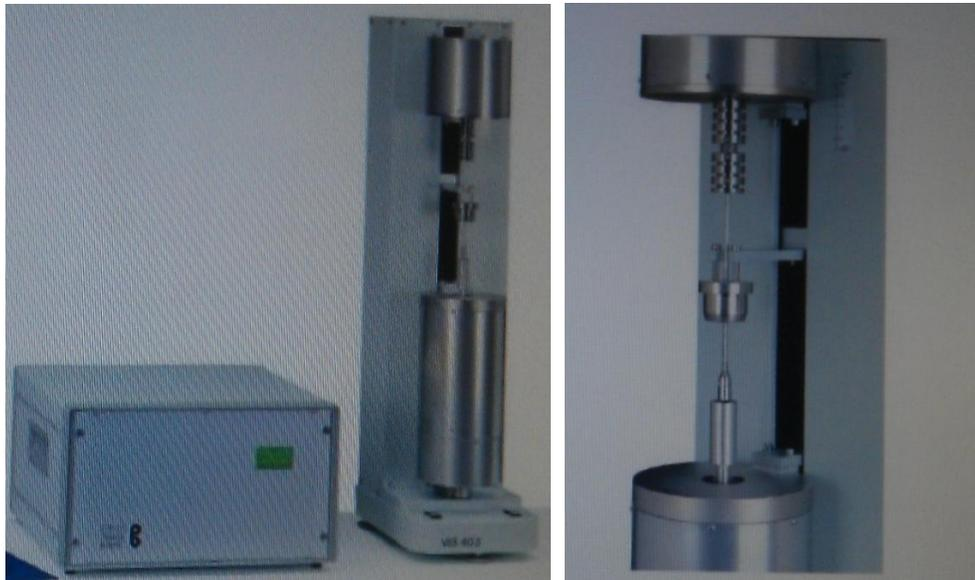
Рисунок 16. Ротационный вискозиметр VIS 403
