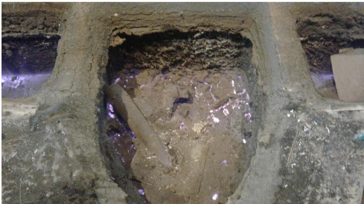
Рисунок 69. Металлоприемное устройство после разливки серии плавов
