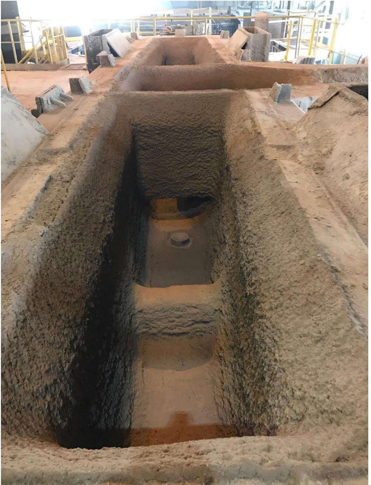
Рисунок 66. Огнеупорная футеровка промежуточного ковша (вид сбоку сверху) с порогами и перегородками со щелевым отверстием
