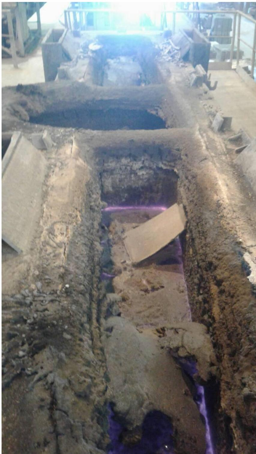
Рисунок 68. Промежуточный ковш после разливки серии плавов
