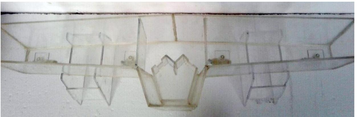
Рисунок 61. Модельная геометрия промежуточного ковша
