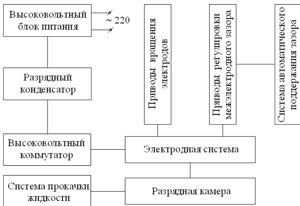
Рисунок 2 – Структурная схема установки для генерации наночастиц в жидкой среде электродуговым импульсным методом
