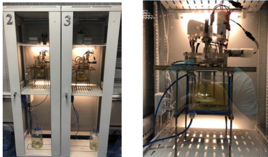
Рисунок 4 – Электр-импульсная установка синтеза наночастиц металлов и их сплавов в жидкой среде
