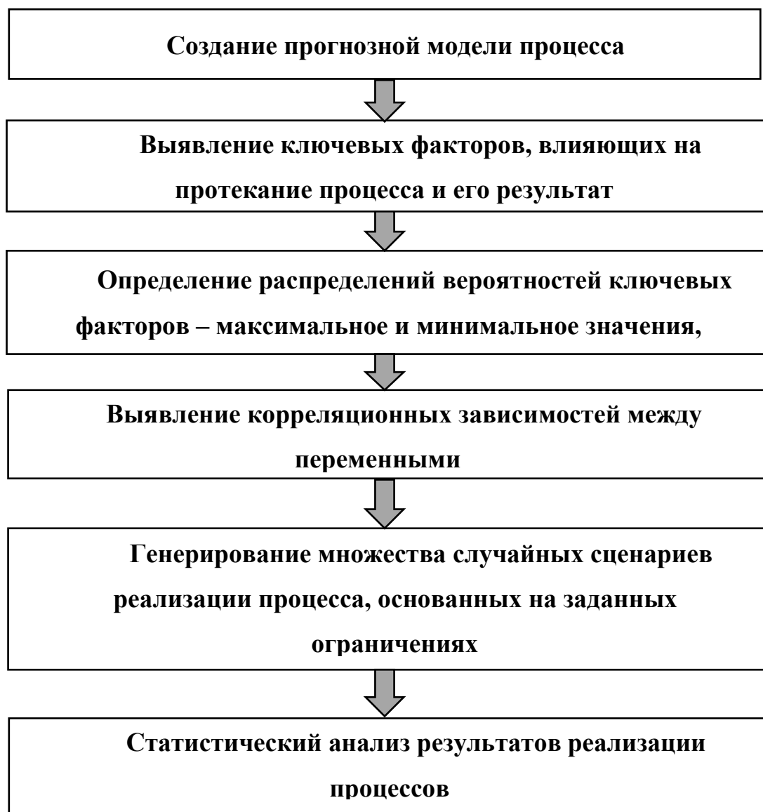
Рисунок 1.3 – Алгоритм выполнения имитационного моделирования с применением метода Монте-Карло
